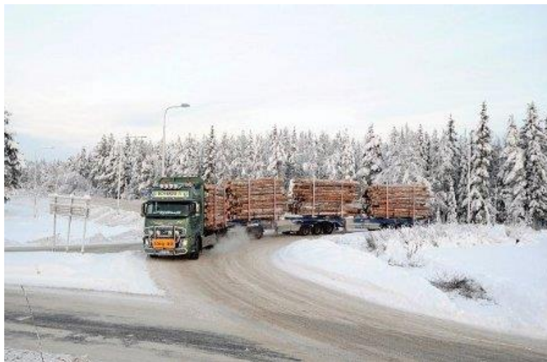
Slika 10. ETT sustav u prometu javnom cestom
