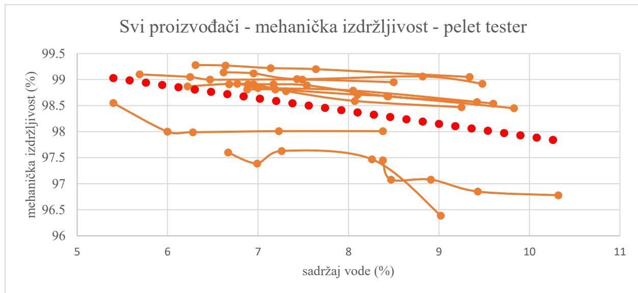
Graf 12. Ovisnost mehaničke izdržljivosti mjerene na pelet-testeru o sadržaju vode kod svih 10 proizvođača
