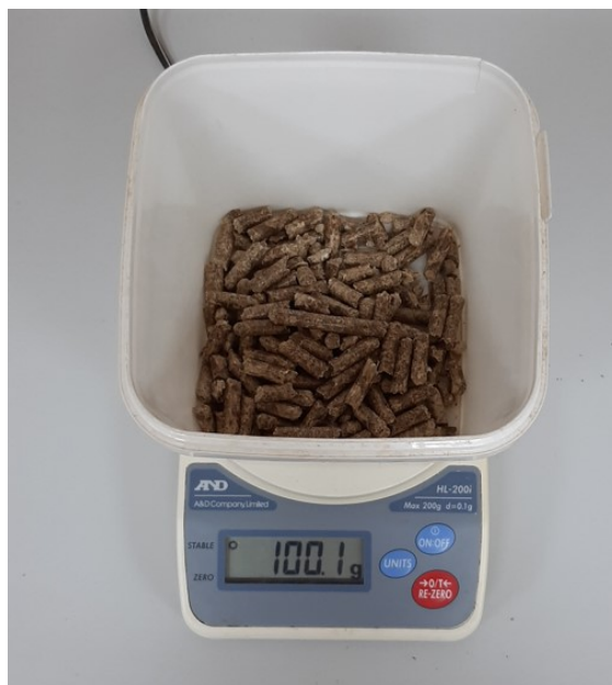
Slika 15. Vaganje uzoraka za ispitivanje na ligno-testeru
