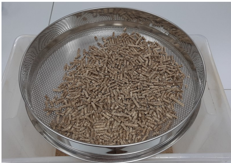
Slika 8. Prosijavanje peleta u situ okruglih otvora 3,15 mm
