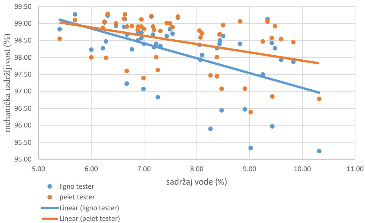
Graf 13. Usporedba ovisnosti mehaničke izdržljivosti o sadržaju vode za ligno-tester i pelet-tester
