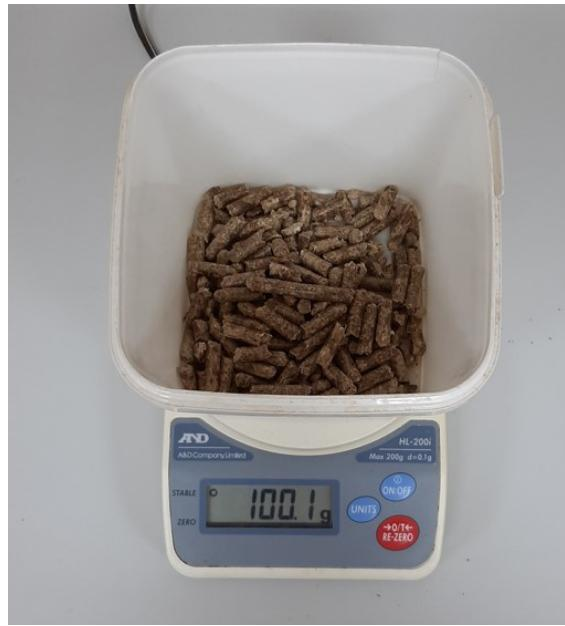
Slika 15. Vaganje uzorka za ispitivanje na ligno-testeru
