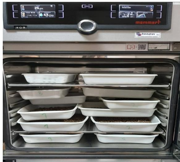
Slika 7. Navlaživanje (kondicioniranje) uzoraka peleta u klima komori
