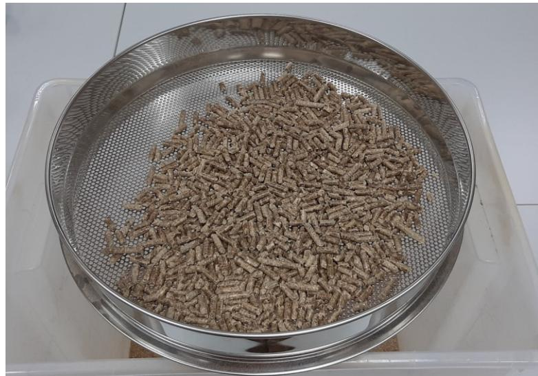
Slika 8. Prosijavanje peleta u situ okruglih otvora 3,15 mm
