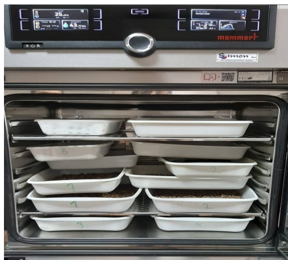
Slika 7. Navlaživanje (kondicioniranje) uzoraka peleta u klima komori
