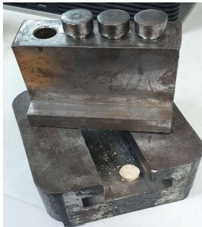
Slika 29. Isprešana tableta od drvene sirovine
