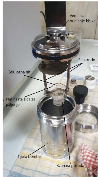
Slika 30. Osnovni dijelovi bombe kalorimetra
