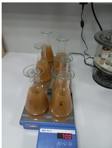
Slika 18. i slika 19. Ekstrakcija na elektromagnetskoj mješalici
