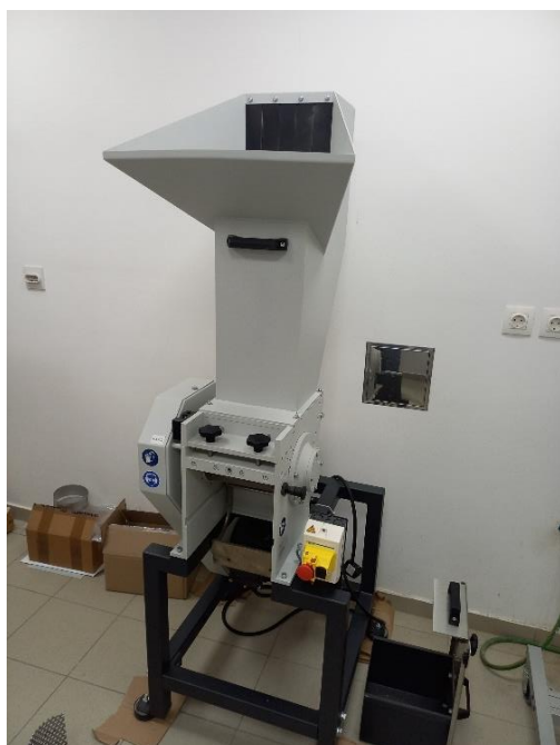
Slika 6. mlin Retsch SM400
