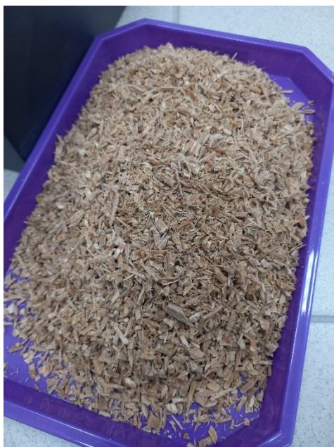
Slika 10. Uzorci za ispitivanje usitnjenog drva (usitnjeni uzorak granulacije 4 mm)
