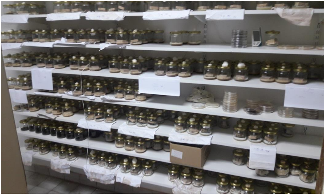
Slika 8. Ispitne flašice s uzorcima izloženima miceliju čiste kulture gljive Gloeophyllum trabeum u mikološkoj klima komori
