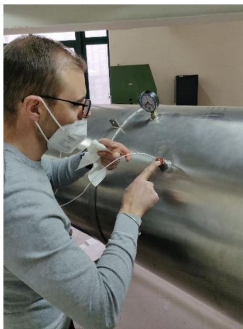
Slika 15: Ugradnja termoparova (fotografija: Kvakon, 2022.)
