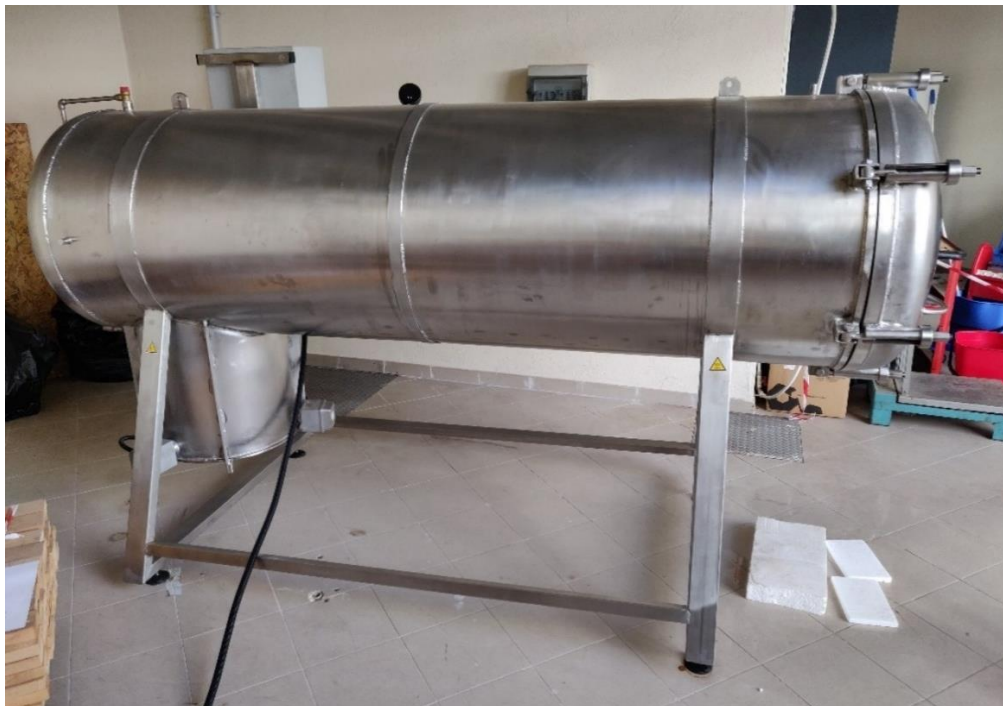
Slika 5: Kotao za parenje pod tlakom (fotografija: Kvakana, 2022.)
