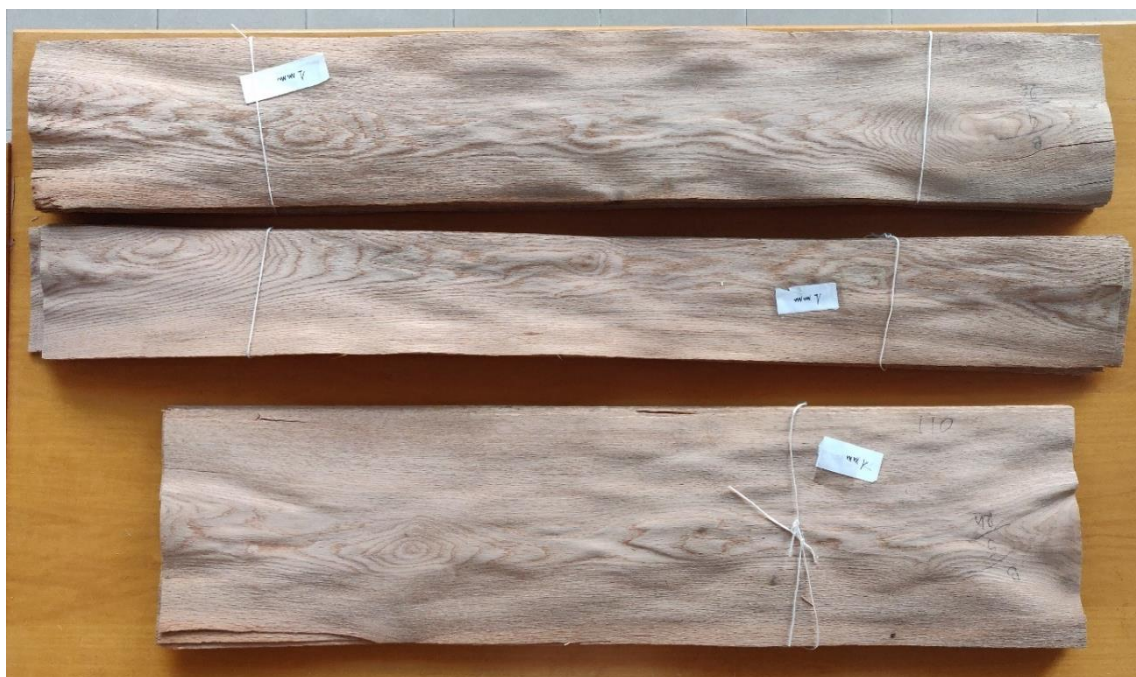
Slika 22: Svežnjevi furnira cerovine debljine 0,6 mm, za izradu uzoraka korišten je najgornji svežanj (fotografija: Kvakon, 2022.)
