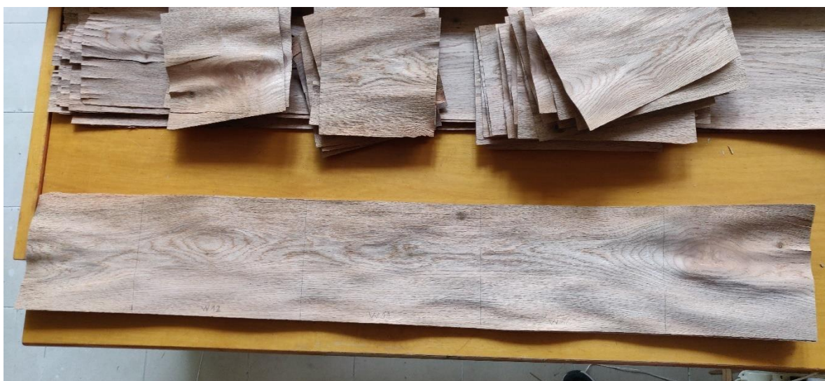
Slika 23: Izrezivanje uzoraka izbjegavajući greške (fotografija: Kvakana, 2022.)
