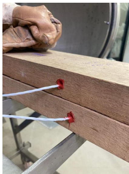
Slika 17: Testiranje termoparova (fotografija: Todaro, 2022.)
