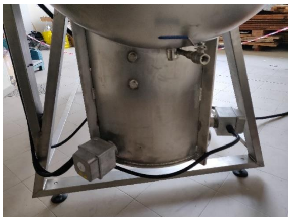
Slika 11: Spremnik za vodu s grijačima, ventil za vodu (fotografija: Kvakon, 2022.)
