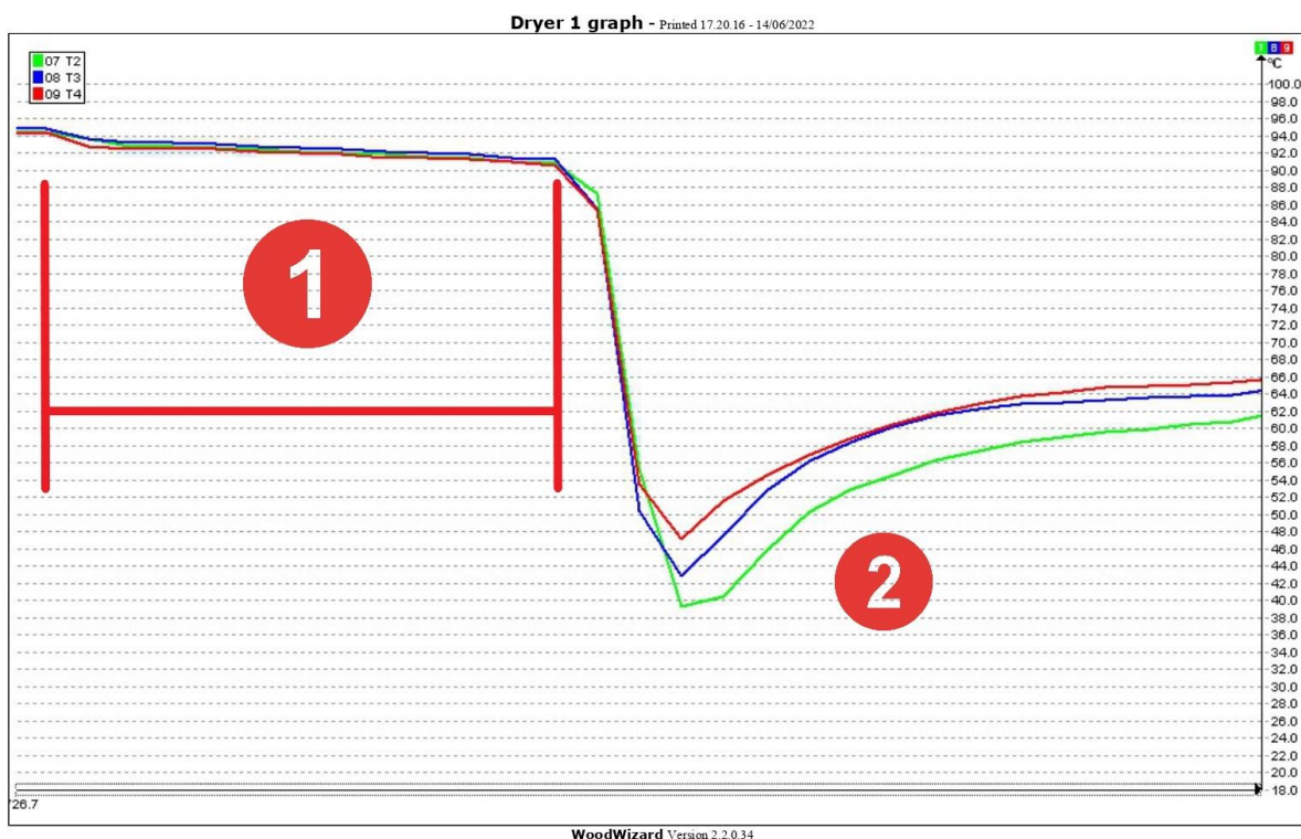
Slika 39: Graf otpuštanja pritiska i otvaranja vrata kotla (izvor: WoodWizard 2.2, Kvakon, 2022.)
