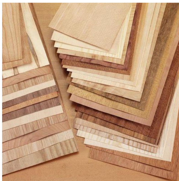
Slika 1: Primjer listova furnira različitih vrsta drva
