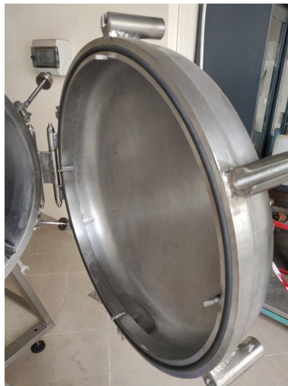
Slika 8: Okrugla vrata kotla s gumenom brtvom i prihvaticima za vijčano učvršćenje vrata (foto: Kvakan, 2022.)
