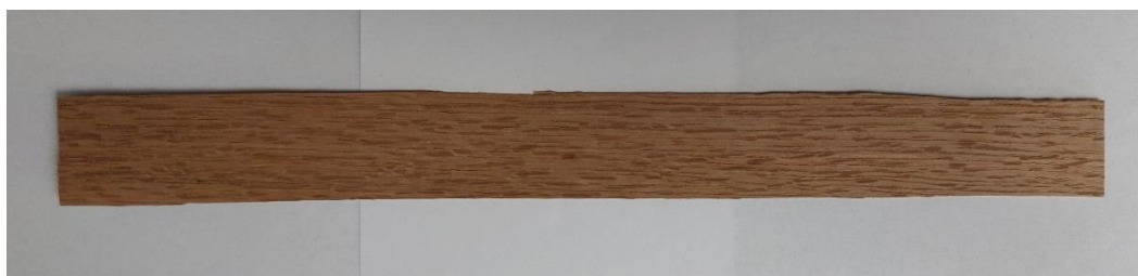
Slika 24: Uzorak cerovine dimenzija 300 x 30 mm (fotografija: Kvakana, 2022.)
