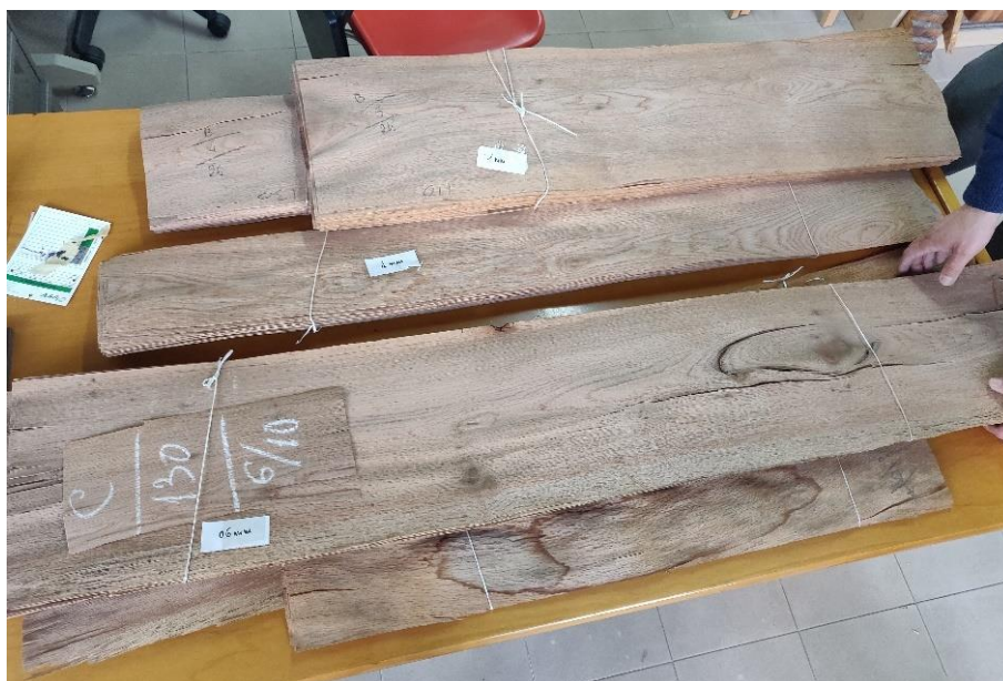
Slika 20: Svežnjevi furnira cerovine (fotografija: Kvakana, 2022.)
