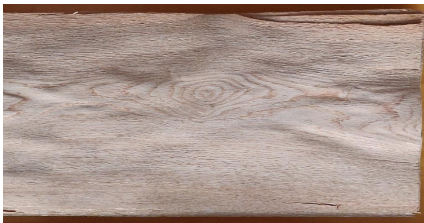
Slika 2: Površina lista furnira cerovine (fotografija: Kvakana, 2022.)
