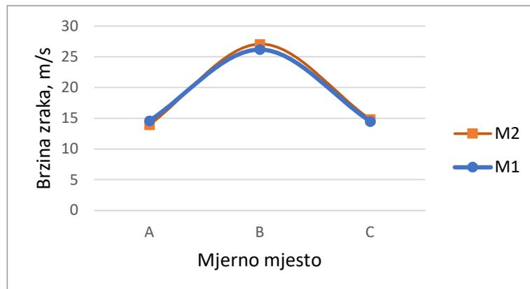
Slika 27. „PUZ“ - promjena brzine po presjeku (80 mm)
