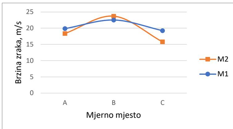
**Slika 35.** „PUH“ - promjena brzine po presjeku (100 mm)
