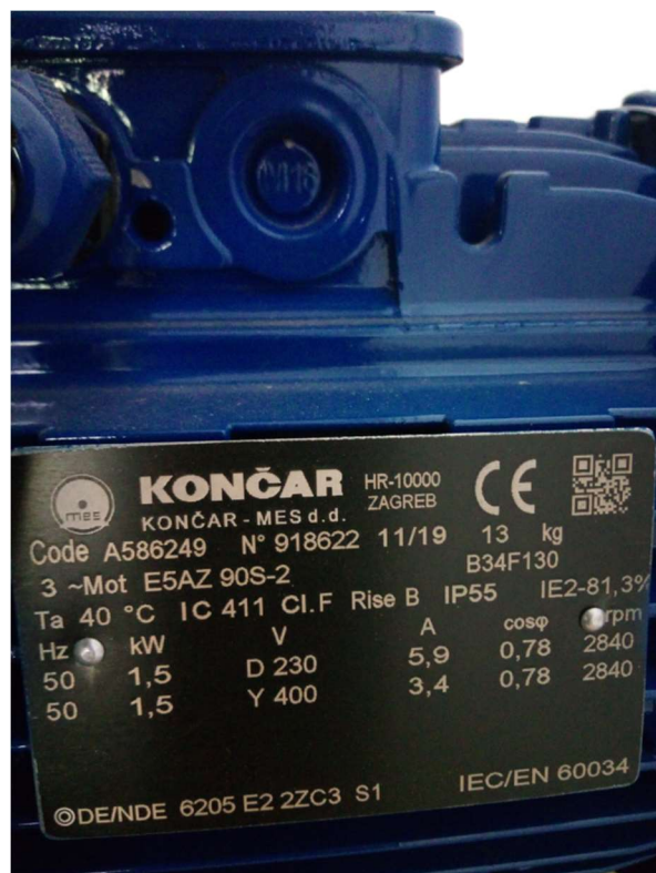
Slika 14. Natpisna pločica elektromotora
