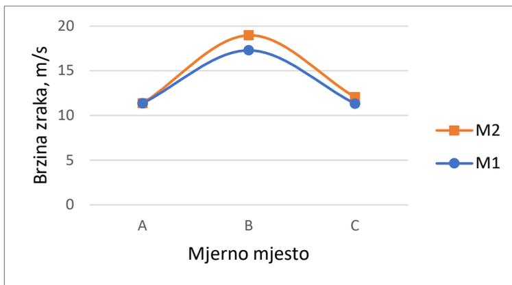
**Slika 50.** „EOLO L“ - promjena brzine po presjeku (140 mm)
