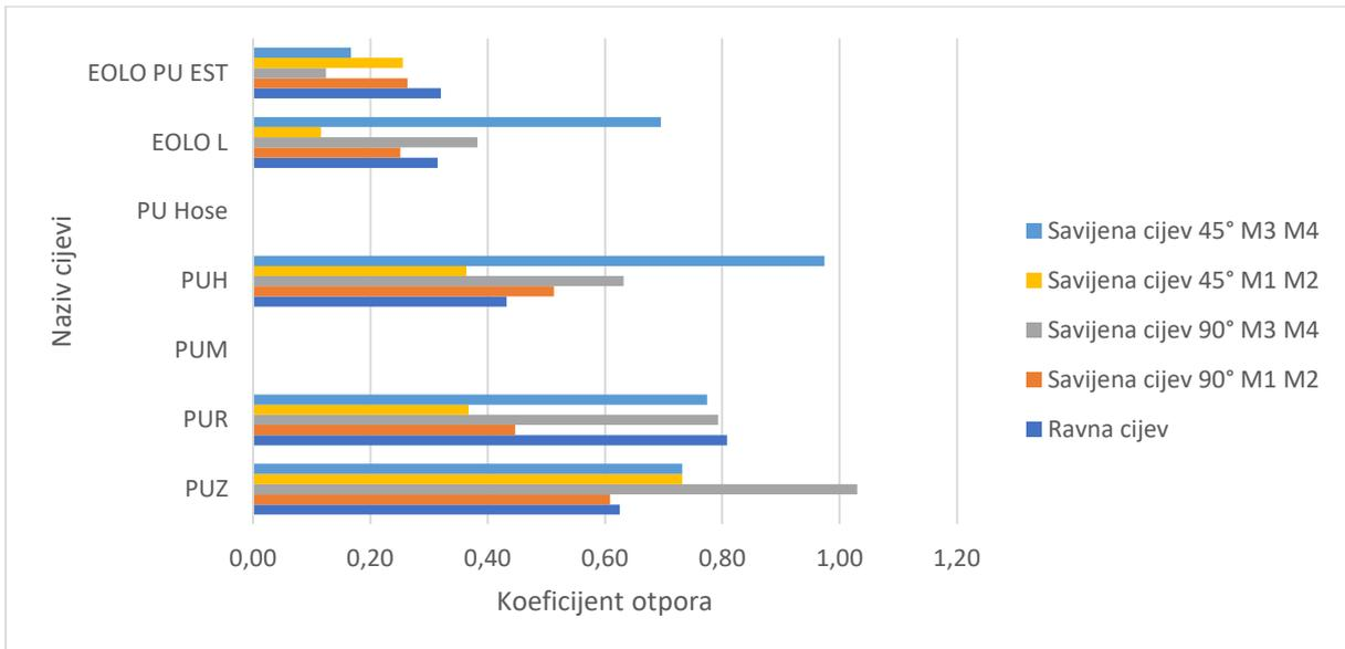
**Slika 64.** Odnos koeficijenta otpora između vrsta cijevi i načina savijanja cijevi (80 mm)
