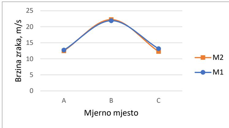
**Slika 49** „PU Hose“ - promjena brzine po presjeku (140 mm)
