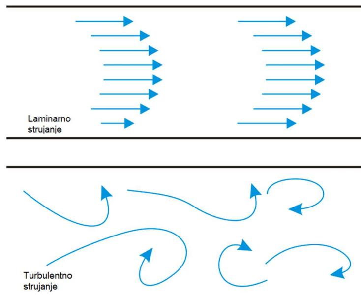
**Slika 2.** Shematski prikaz laminarnog i turbulentnog strujanja
