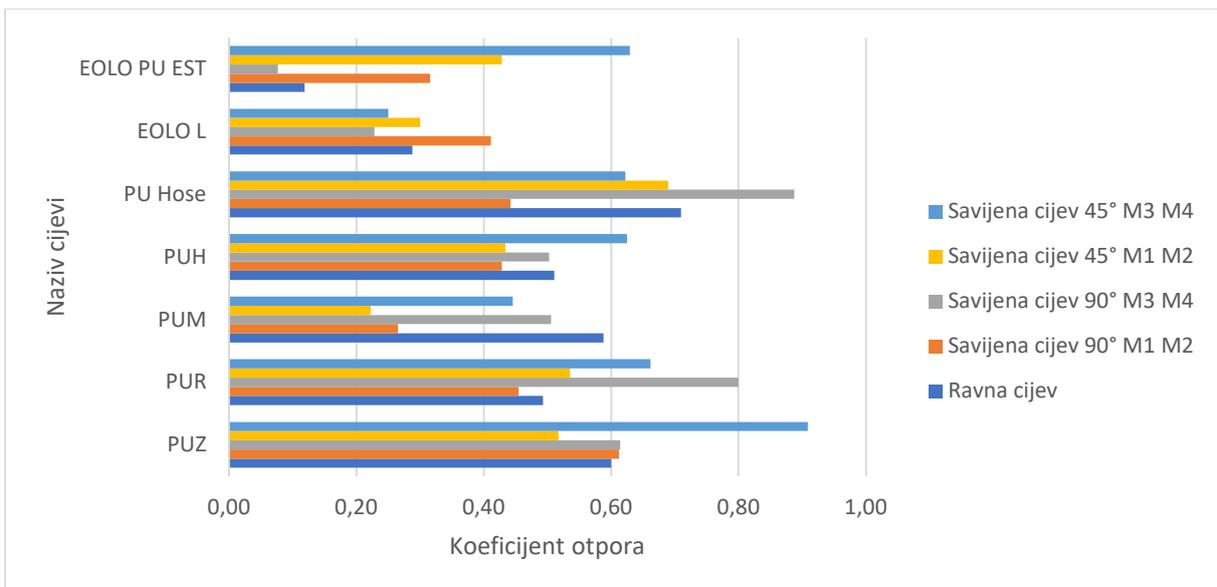
**Slika 65.** Odnos koeficijenta otpora između vrsta cijevi i načina savijanja cijevi (100 mm)
