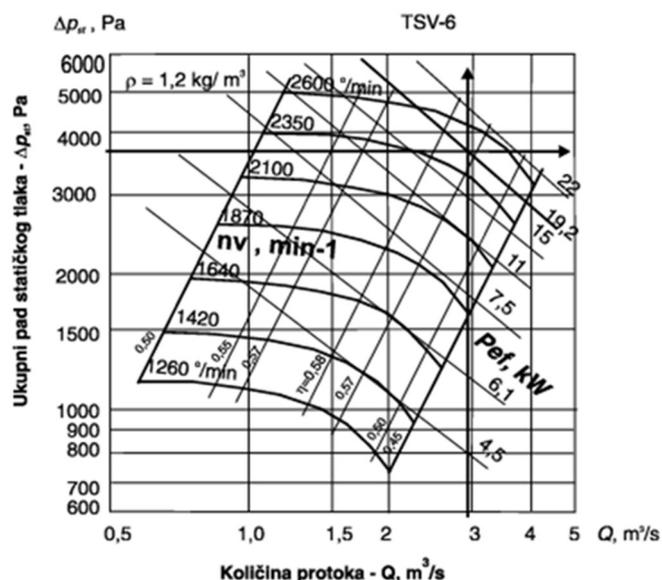
Slika 13. Dijagram statičkih tlakova za ventilator TSV-6
