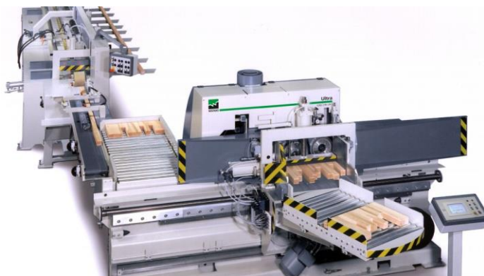
Slika 32 Weinig stroj za spajanje kratkih elemenata (Izvor: https://intercet.si/hr/produkt/linije-za-duzinsko-spajanje-kratkih-elemenata-weinig-ultraultra-tt , Pristupljeno: 3.9.2022.)
