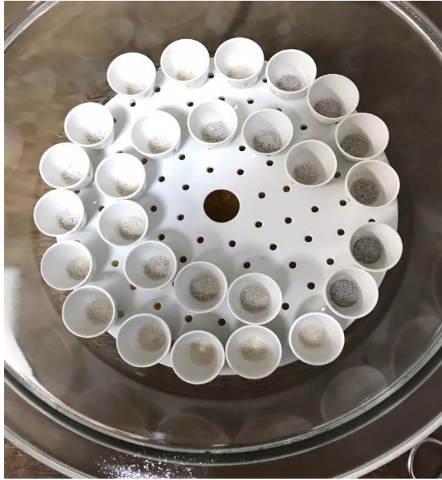
Slika 18. Uzorci 10 grupa nakon žarenja
