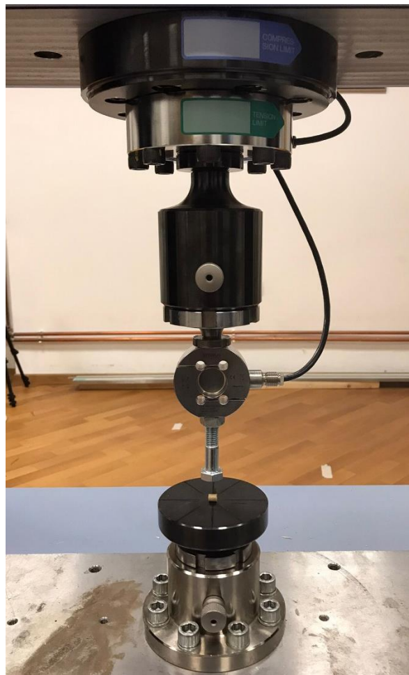
Slika 26. Položaj uzorka u kidalici Shimadzu Autograph AGX plus
