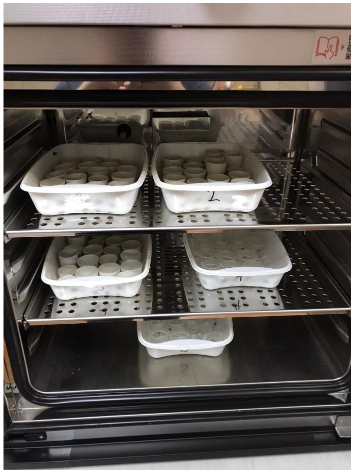
Slika 24. Peleti u klima komori Memmert
