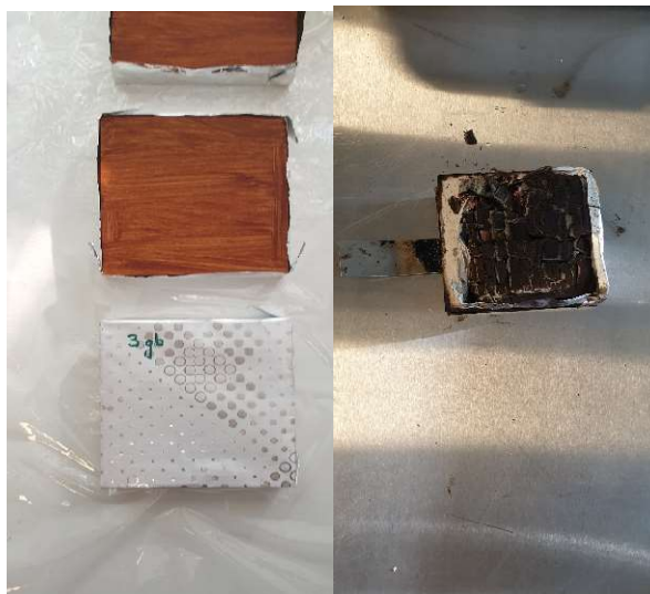
Slika 8. Uzorci bukve za ispitivanje vatrootpornosti prije i nakon ispitivanja na konusnom kalorimetru
