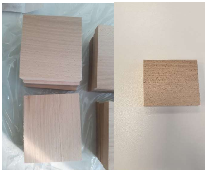
Slika 10. Uzorci bukve za ispitivanje vatrootpornosti prije procesa impregnacije
