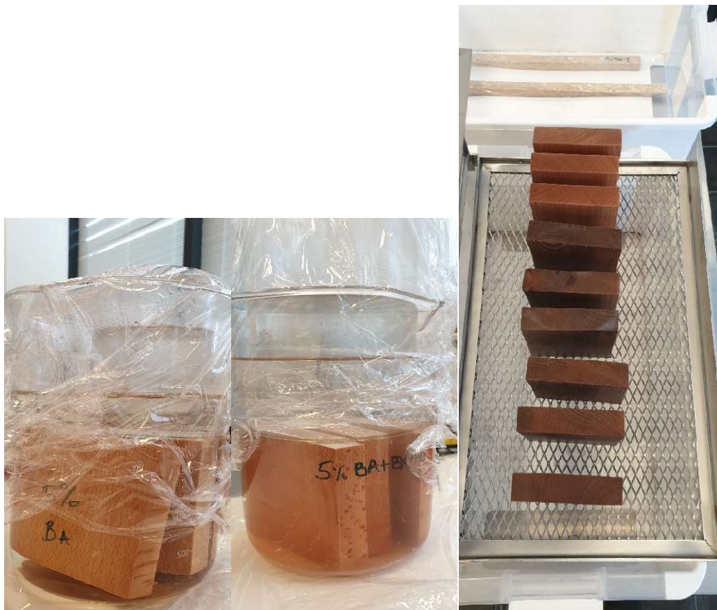
Slika 15. Kemijske komponente pripremljene kao vodene otopine u svrhu impregniranja ispitnih uzoraka za ispitivanje vatrootpornosti, tijekom i nakon procesa impregnacije i prikaz procesa kapanja
