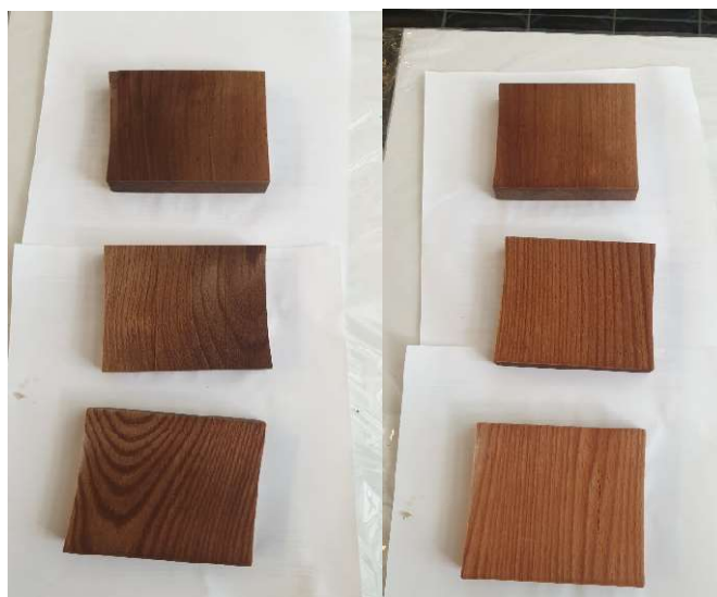
Slika 11. Uzorci bukve za ispitivanje vatrootpornosti nakon procesa impregnacije
