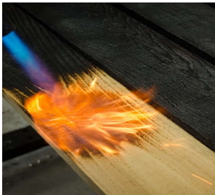
Slika 3. Zapaljivanje površine drva
