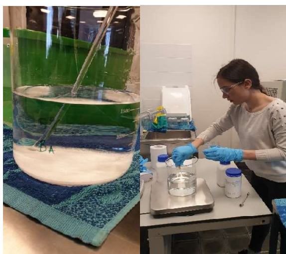
Slika 13. Priprema vodenih otopina impregnacijskog sredstva
