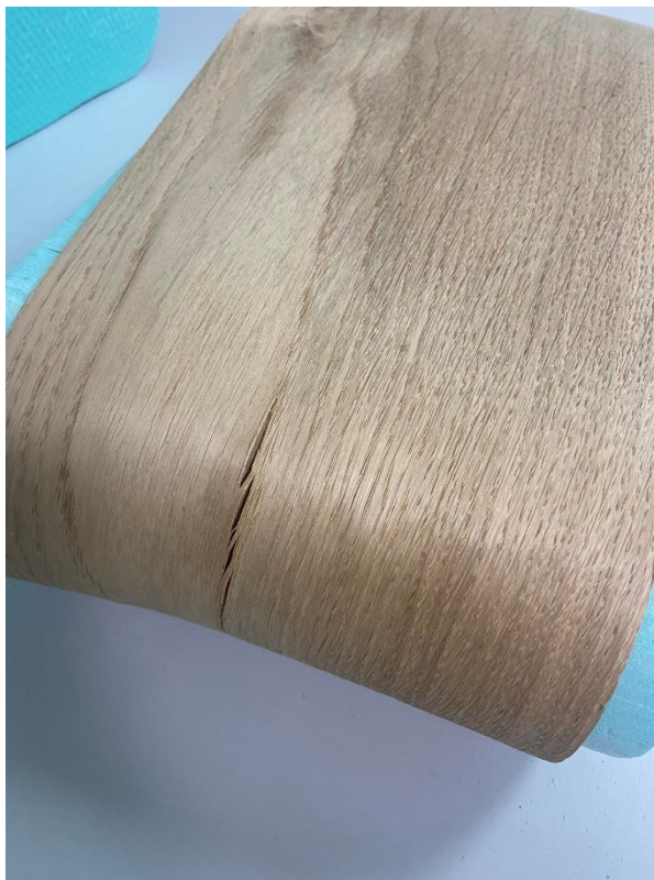
Slika 21. Prikaz pukotine nastale sušenjem (zatezanjem) furnira.
