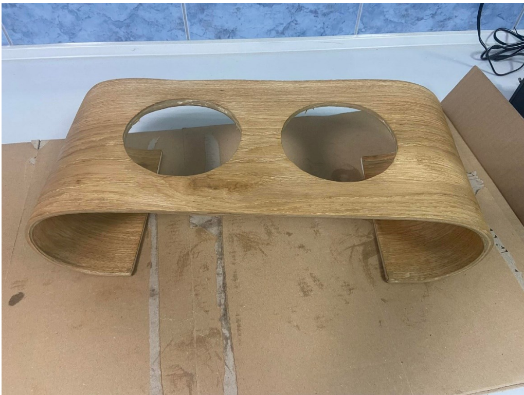
Slika 26. Prikaz prvog sloja uljnog premaza.
