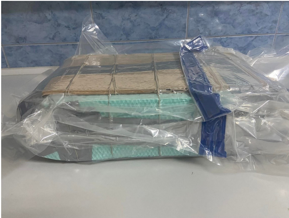
Slika 23. Prikaz vakuumiranja furnira.
