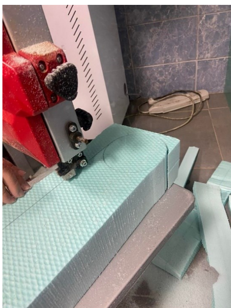
Slika 19. Prikaz piljenja šablone na tračnoj pili.
