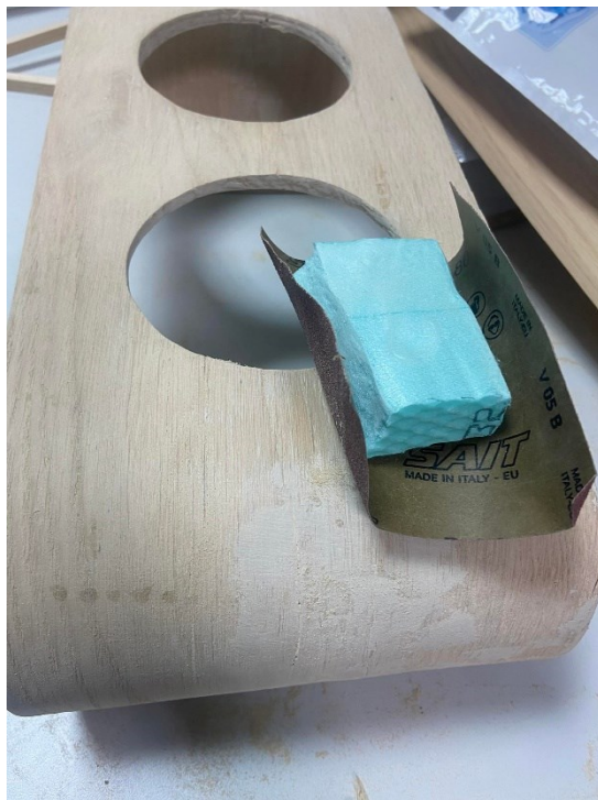
Slika 25. Prikaz brušenja nepravilnosti.
