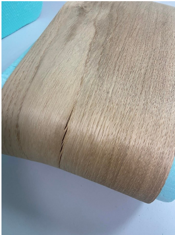
Slika 21. Prikaz pukotine nastale sušenjem (zatezanjem) furnira.
