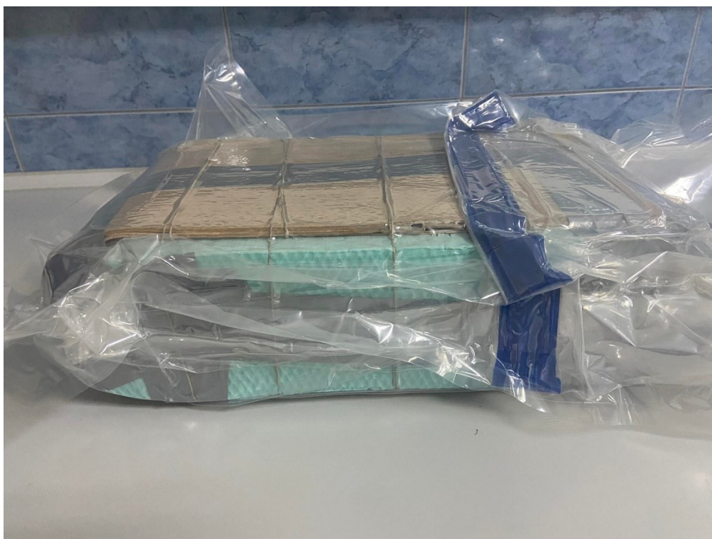
Slika 23. Prikaz vakuumiranja furnira.
