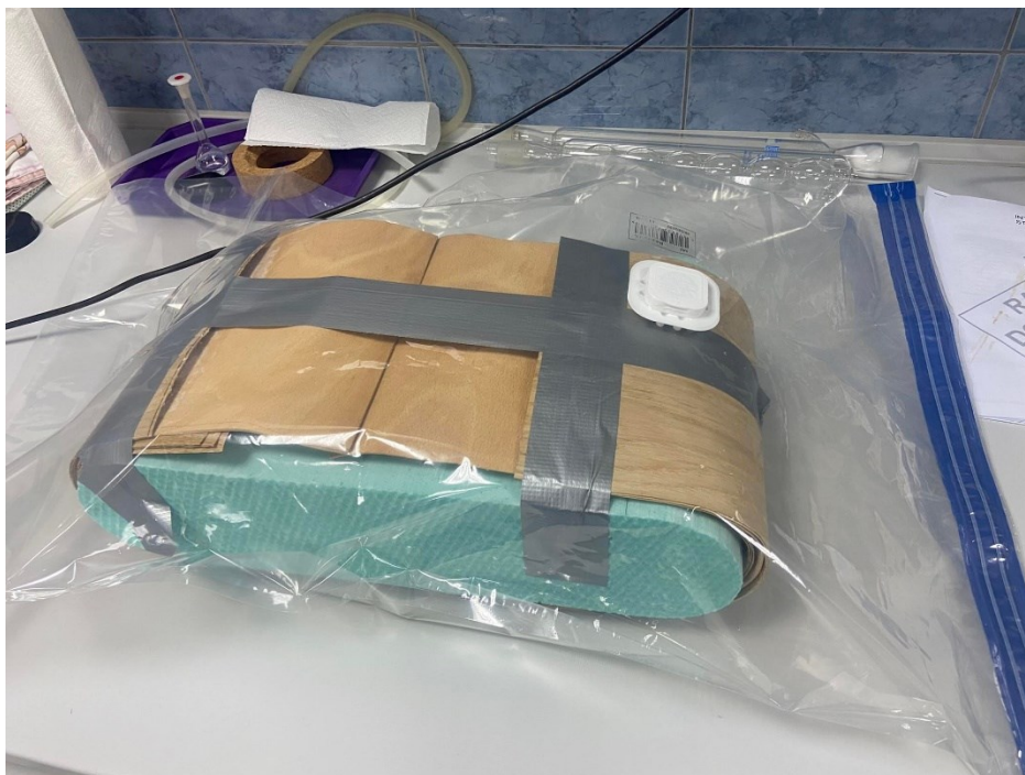
Slika 22. Prikaz vakuumiranja furnira.
