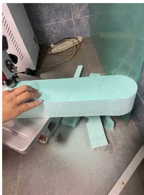
Slika 20. Prikaz piljenja šablone na tračnoj pili.
