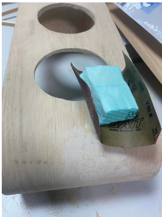
Slika 25. Prikaz brušenja nepravilnosti.
