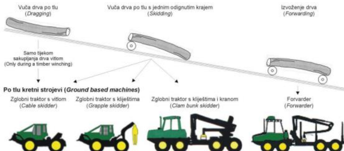
Slika 1. Načini privlačenja drva po tlu (Krpan i dr. 2003)
