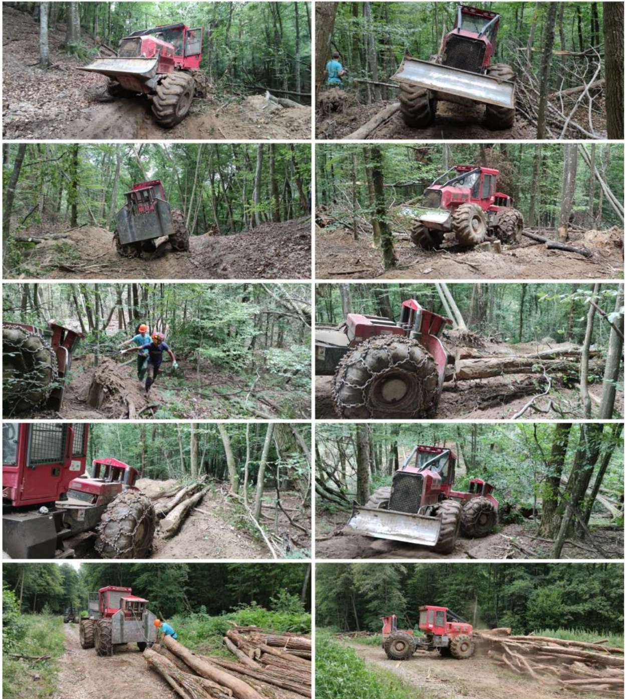
Slika 7. Skider s vitlom Camox F140
