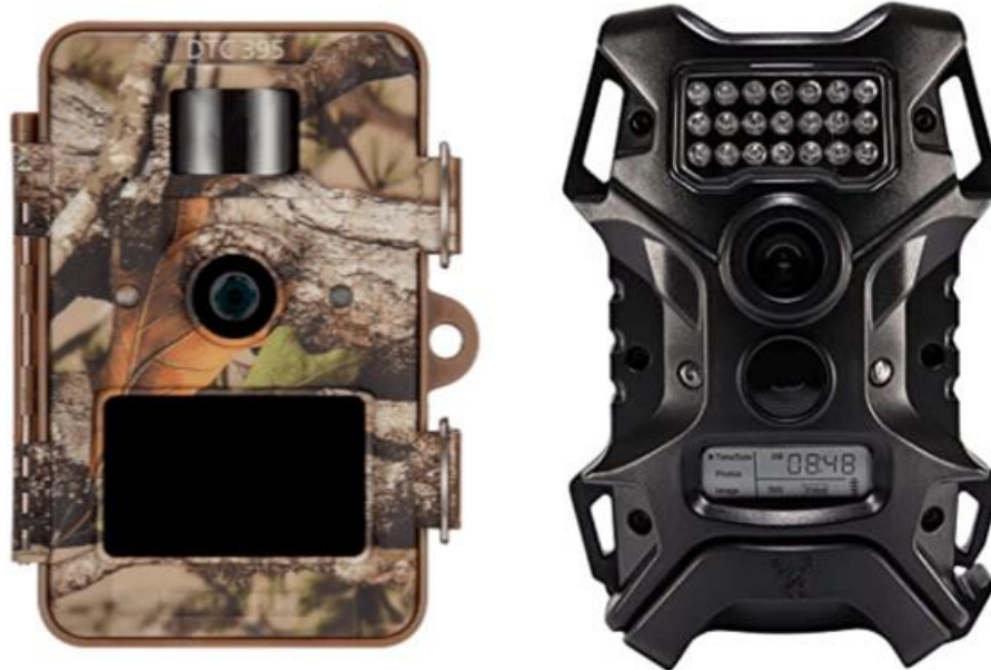
Slika 29. Foto-senzorne kamere (lijevo: Minox DTC 395, desno: Wildgame Innovations Terra Extreme 10) koje su korištene prilikom istraživanja
