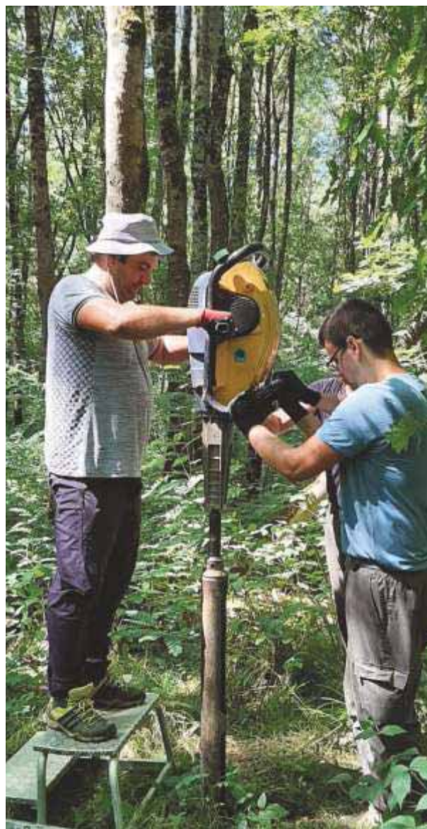
Slika 44 Doc. dr. sc. Ivan Perković strojno uzorkuje tlo na području Lonjskog polja 2021. godine
