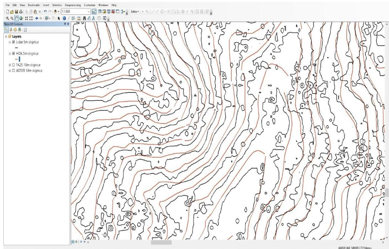
Slika 28. Usporebe slojnica HOK-LiDAR u programu ArcMap
