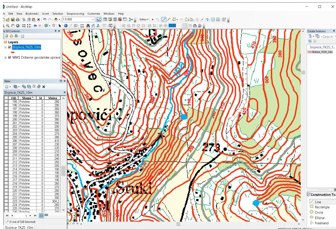
Slika 4. Primjer postupka vektorizacije slojnica na računalu
