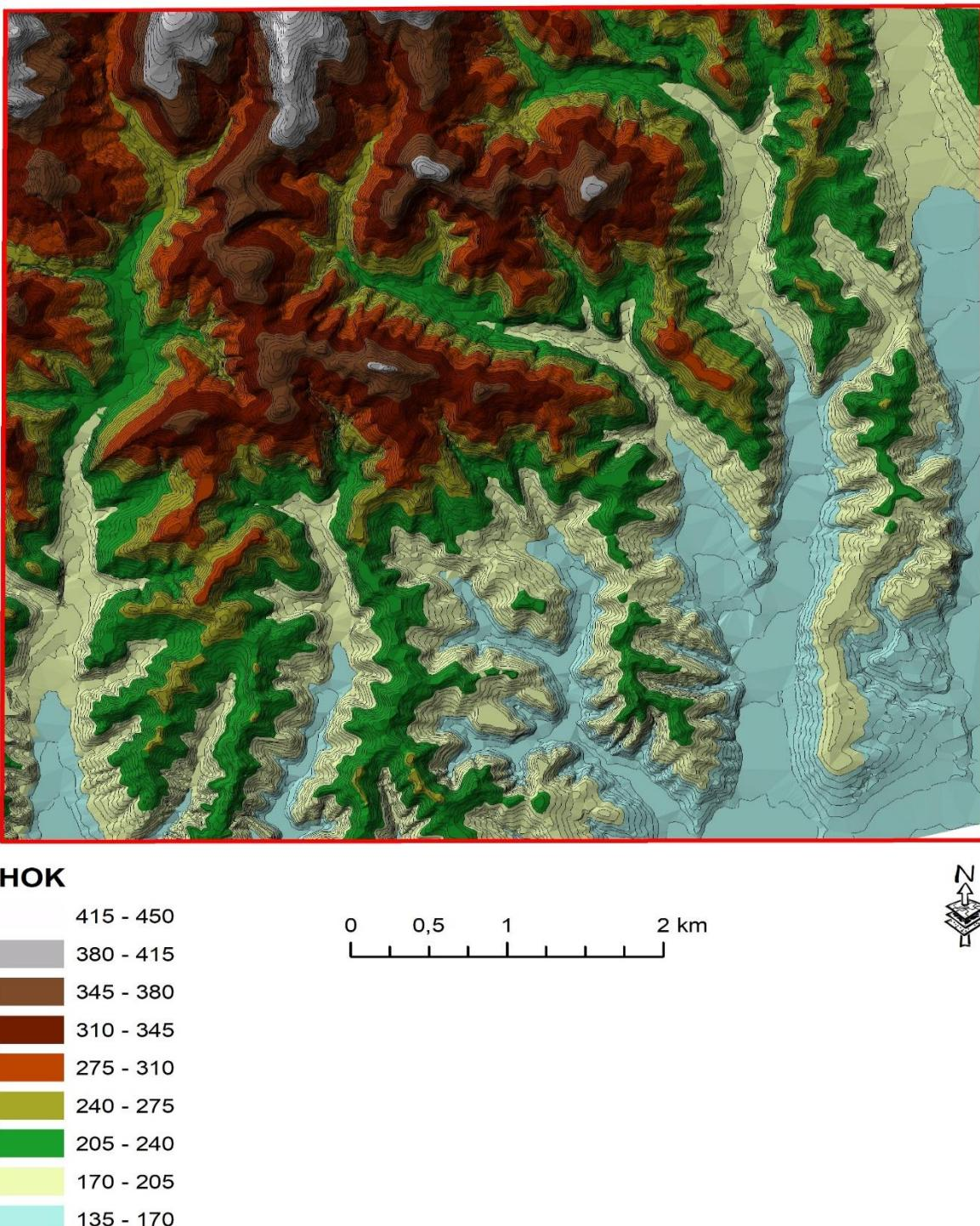
Slika 33. TIN model dobiven iz vektoriziranih slojnic na HOK
