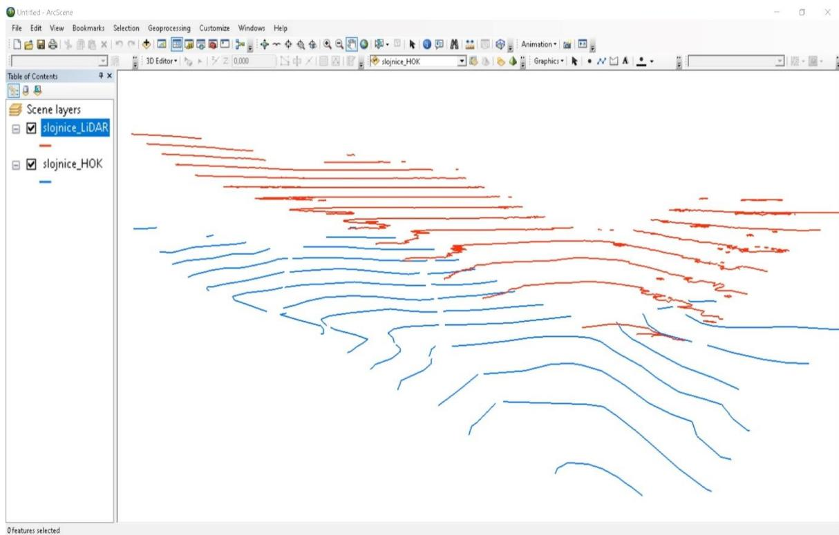
Slika 27. Usporedba slojnica LiDAR- HOK u programu ArcScene
