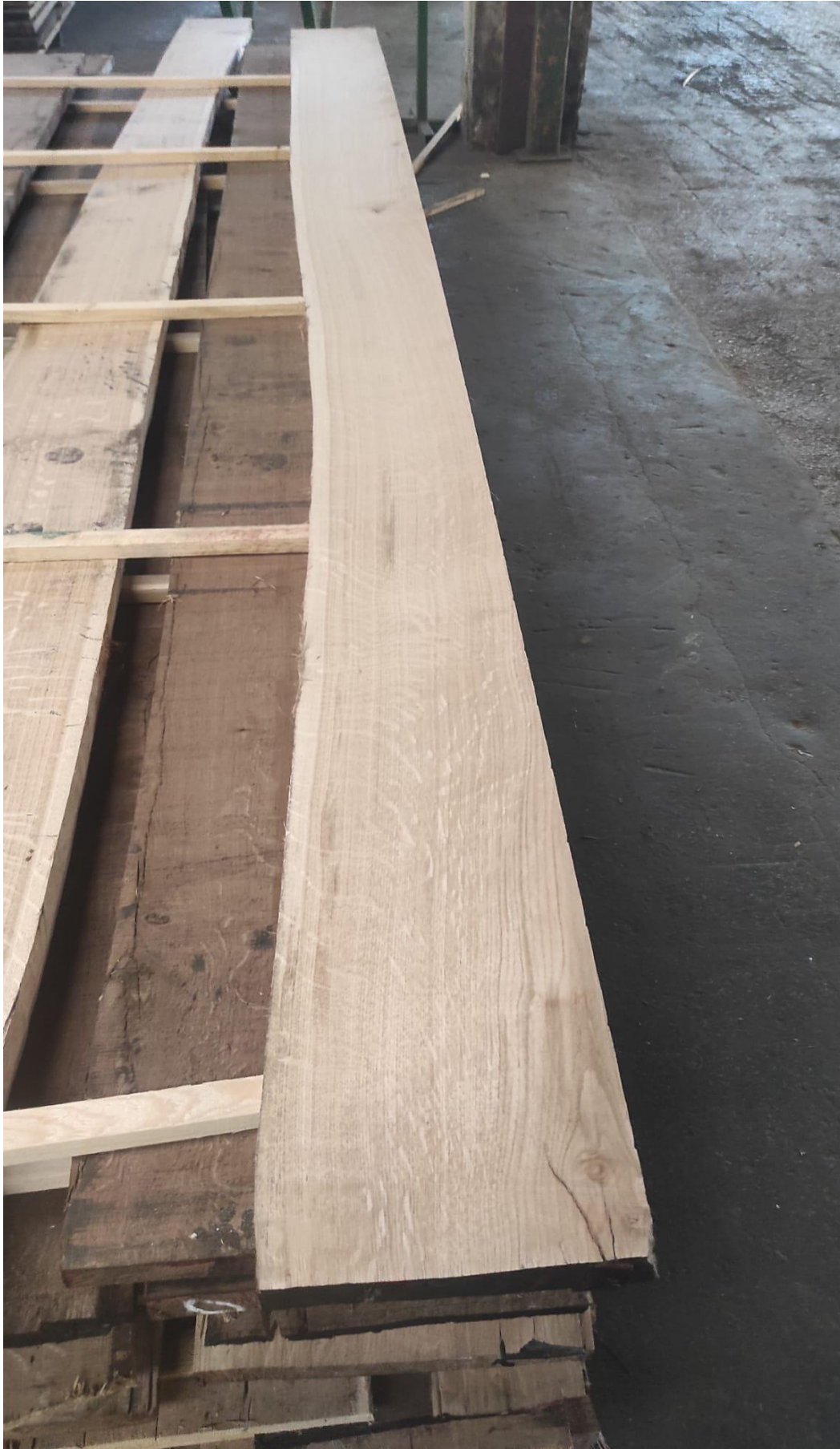
Slika 12 Ostatak od vertikalnog furnirskog noža (meserest) (foto: Krznarić I., 2023.)
