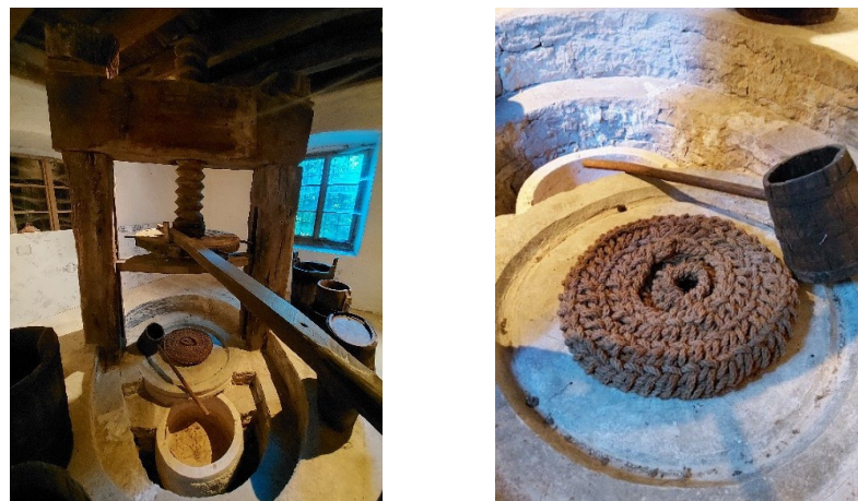
Slika 49. Preša za tiještenje maslina s detaljem športe (Fotografija: Lukež, 2023).
