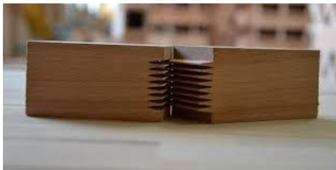
Slika 19. Dužinsko spajanje klinastim zupcima
