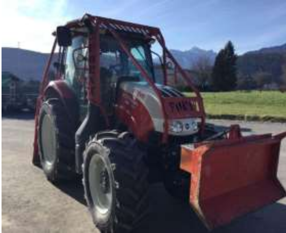
Slika 5. Adaptirani poljoprivredni traktor
