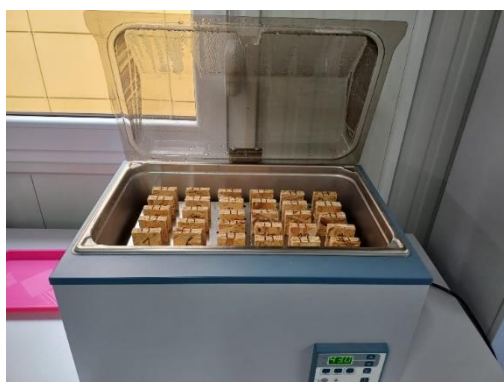
Slika 10. Vodena kupelj s uzorcima (Foto: Plečko, 2023.)
