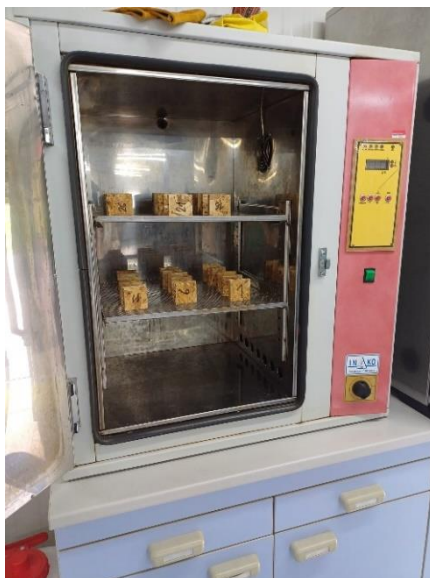
Slika 9. Laboratorijski sušionik s uzorcima (Foto: Žutić, 2021.)
