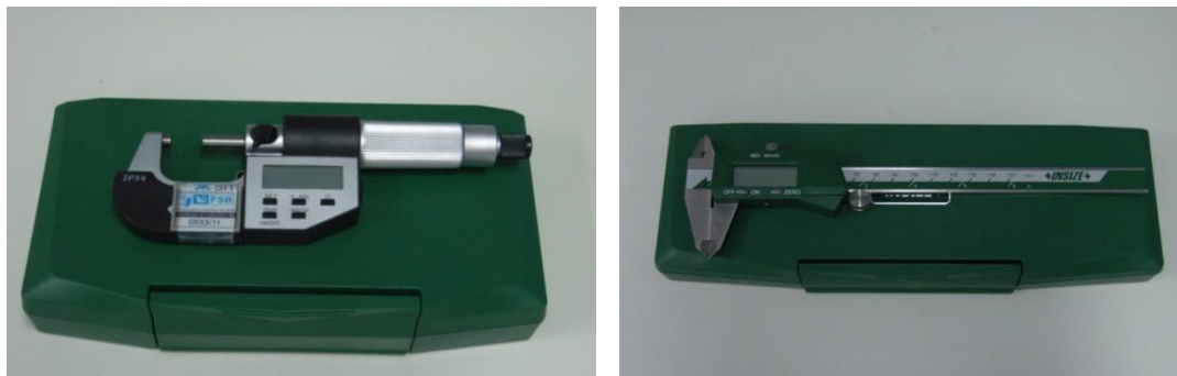
Slika 11. Digitalni mikrometar i pomično mjerilo (Foto: Maleta, 2011.)
