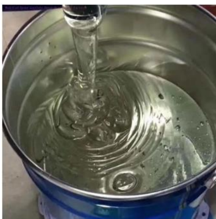
Slika 31. Primjer epoksi akrilatnog oligomera (Echemi.com Provide Better Products and Services, 2023)
