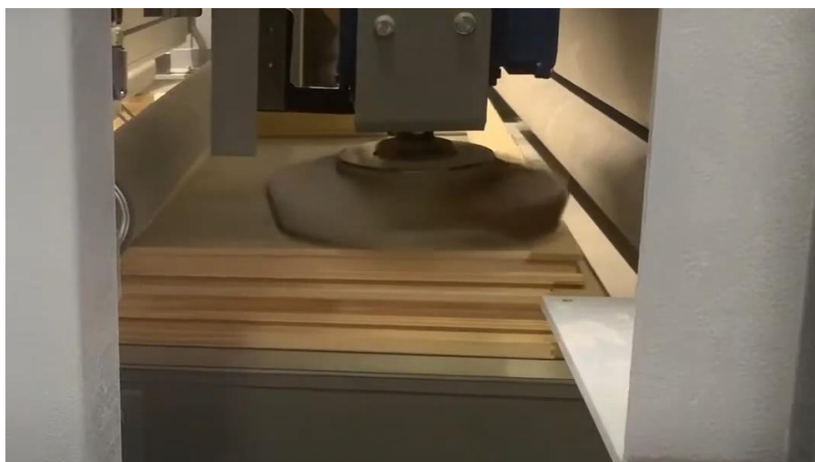
Slika 8 Brušenje četkama ( www.scosarg.com )
