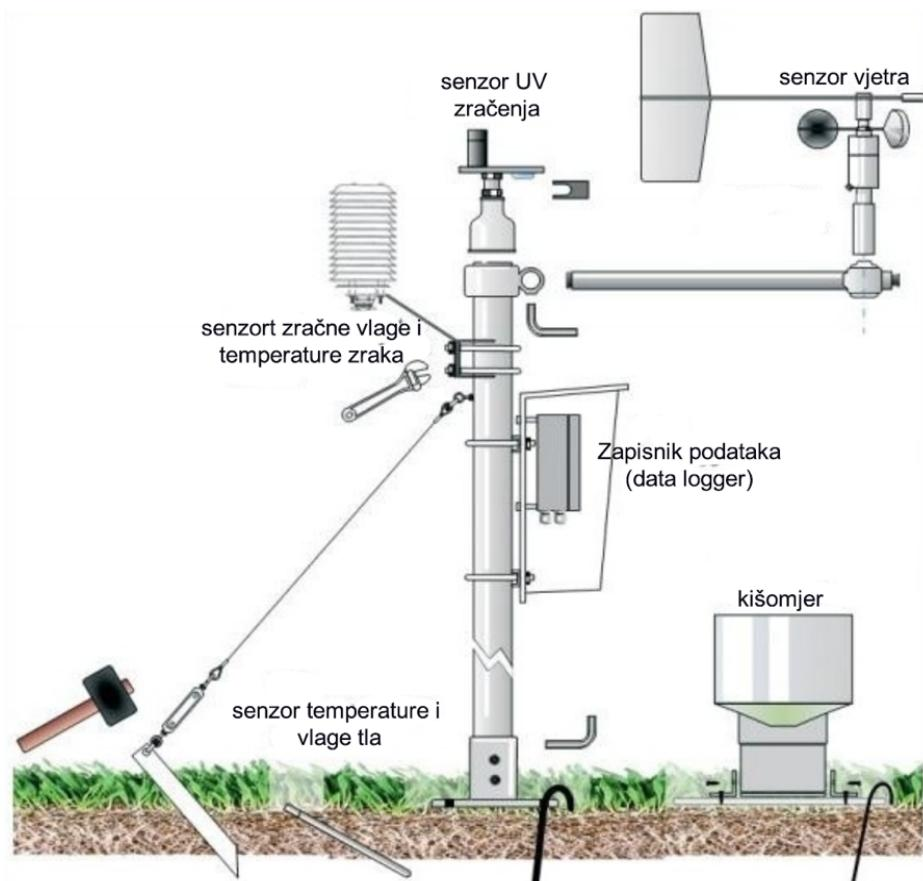
Slika 3 Automatska meteorološka stanica sa osnovnim senzorima za mjerjenje
