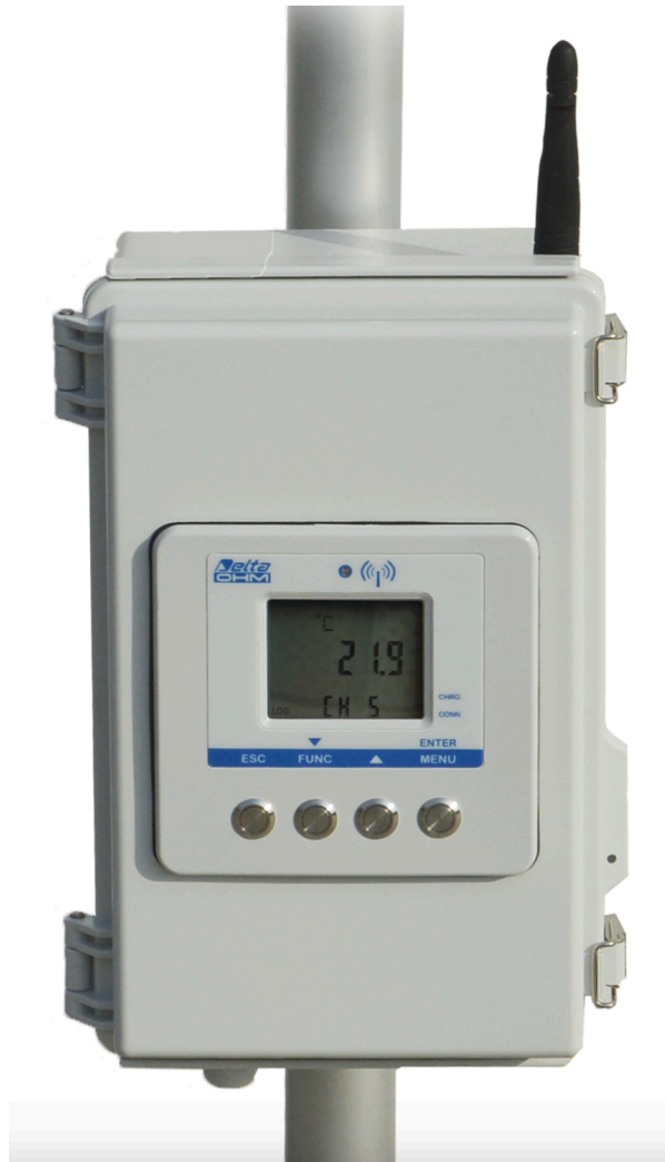
Slika 16 Zapisnik podataka (data logger)
