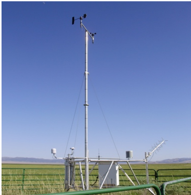
Slika 2. Automatska meteorološka stanica
