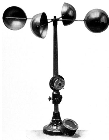
Slika 7. Robinsonov anemometar (lopatasti)
