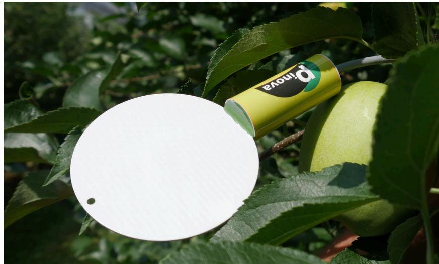
*Slika 15 senzor vlage lista*
