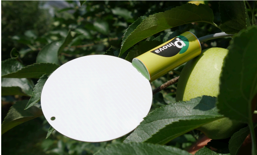
Slika 15 senzor vlage lista
