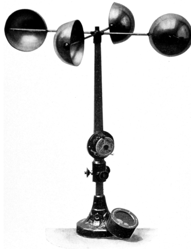
Slika 7. Robinsonov anemometar (lopatasti)
