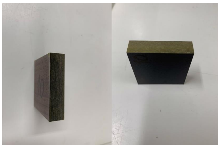
Slika 27. Utjecaj nitratne kiseline nakon 2 sata tretiranja Compact ploča
