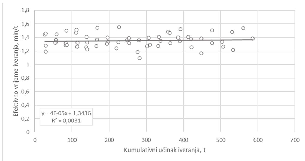
Slika 27. Ovisnost efektivnog vremena iveranja o kumulativnom učinku
