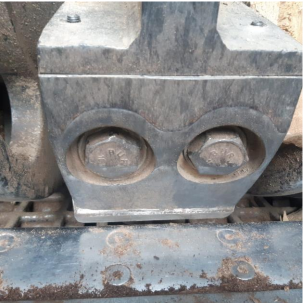
Slika 4. Nož i kontranož na bubanjskom iveraču
