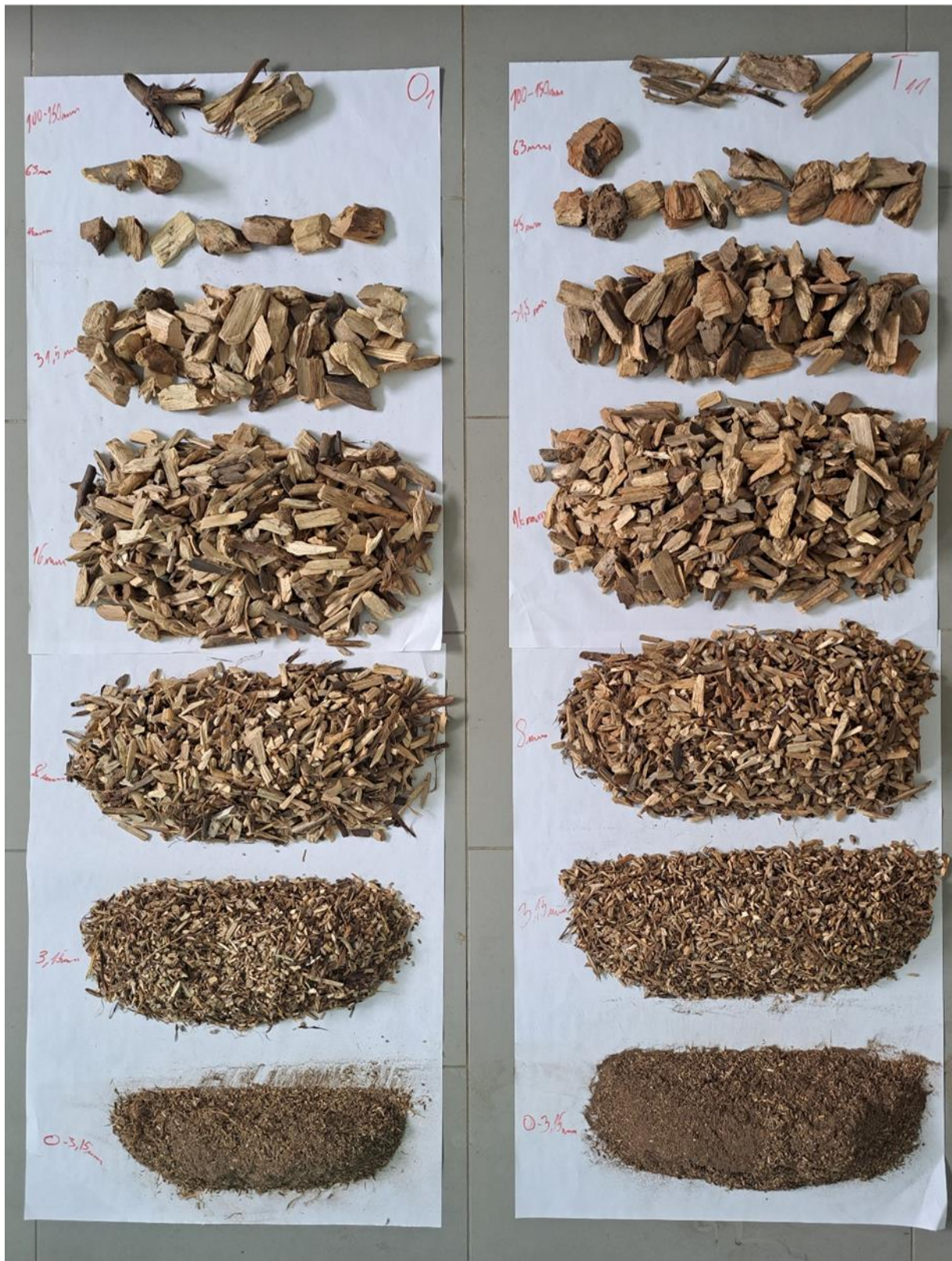
Slika 31. Uzorak drvene sječke prosijan na frakcije, lijevo uzorak O1 (oštri noževi) i desno uzorak T11 (tupi noževi)
