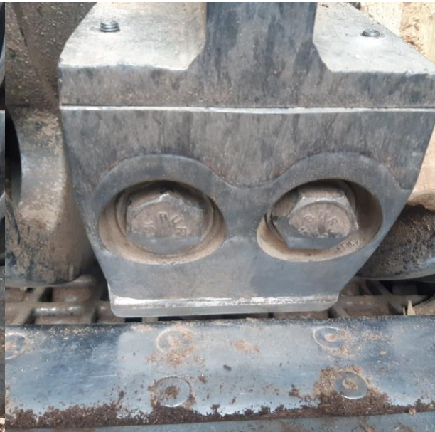
Slika 4. Nož i kontranož na bubanjskom iveraču
