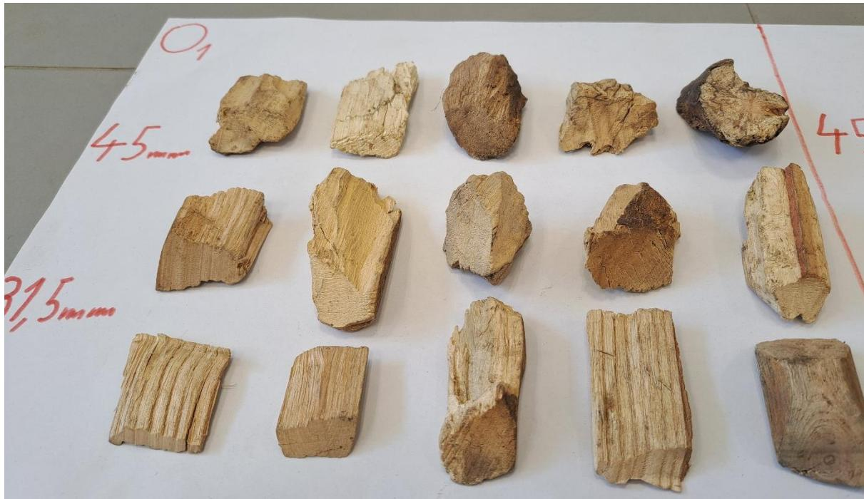
Slika 32. Uzorak O1 proizведен oštrim noževima
