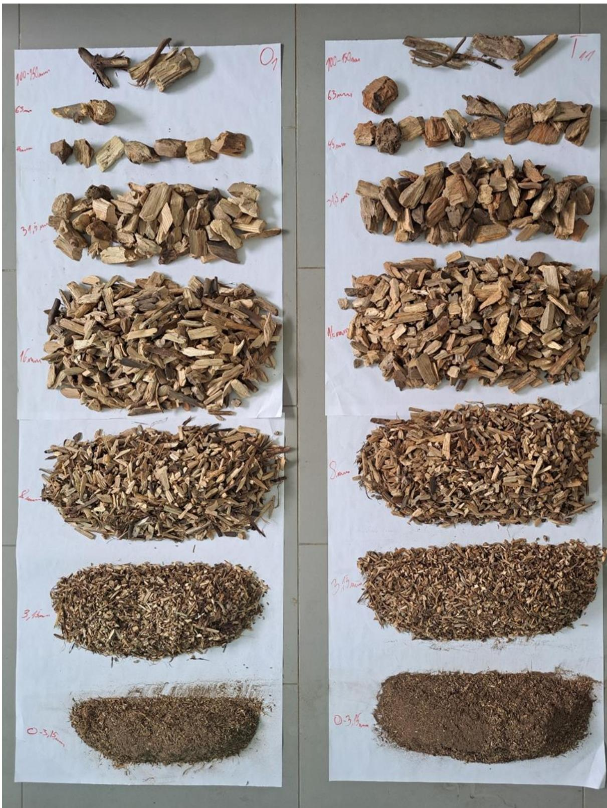
Slika 31. Uzorak drvne sječke prosijan na frakcije, lijevo uzorak O1 (oštri noževi) i desno uzorak T11 (tupi noževi)
