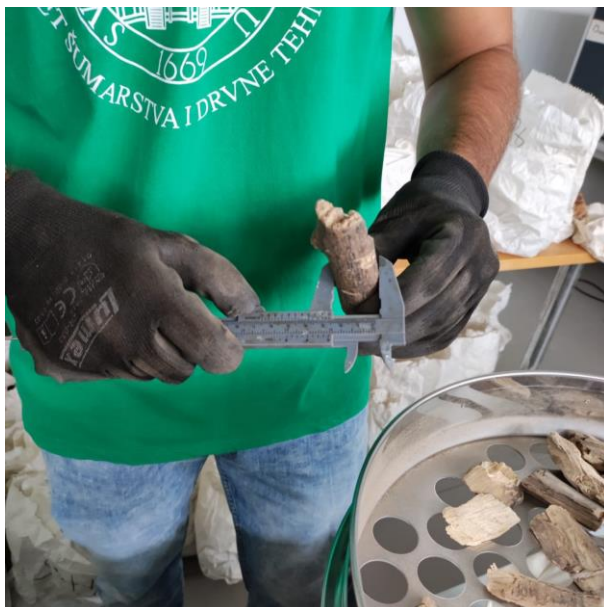
Slika 23. Izmjera srednjeg promjera
