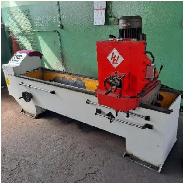
Slika 14. Stroj za oštrenje noževa »GRINDER 1700AM«
