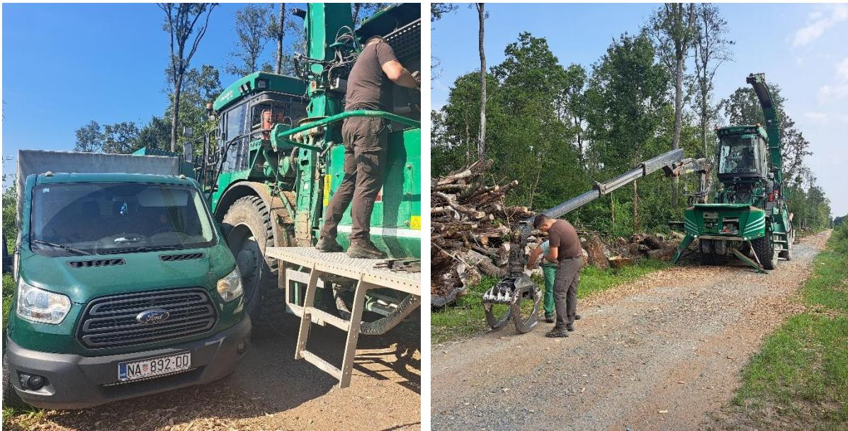
Slika 25. Promjena noževa i točenje goriva
