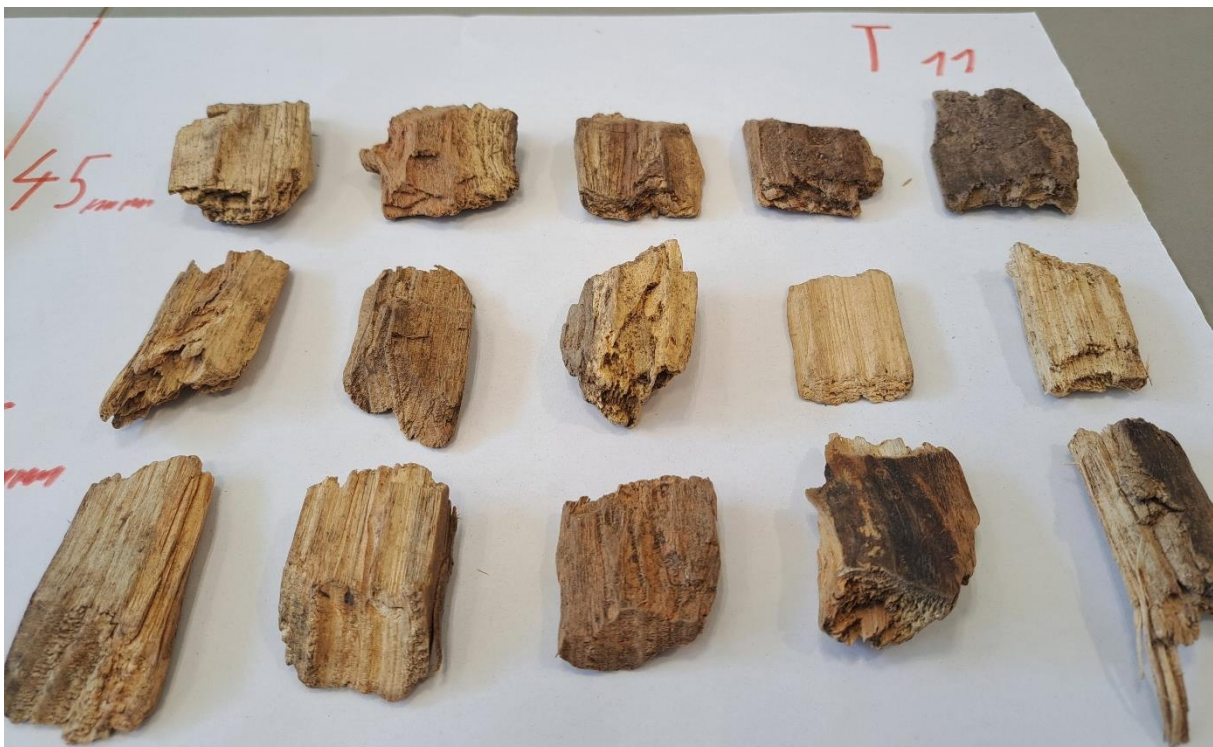
Slika 33. Uzorak T11 proizveden tupim noževima
