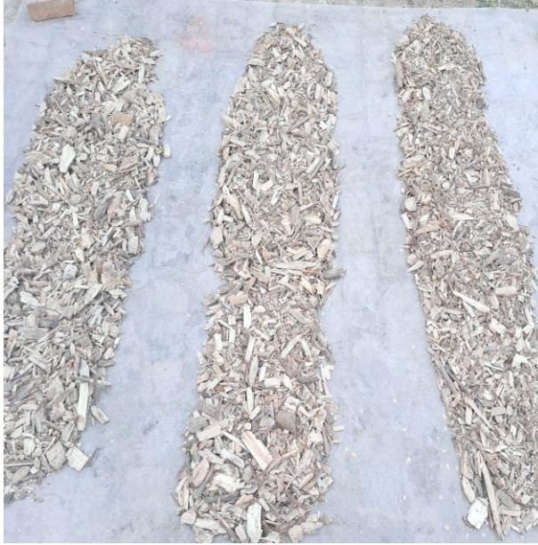
Slika 19. Prirodno prosušivanje drvene sječke
