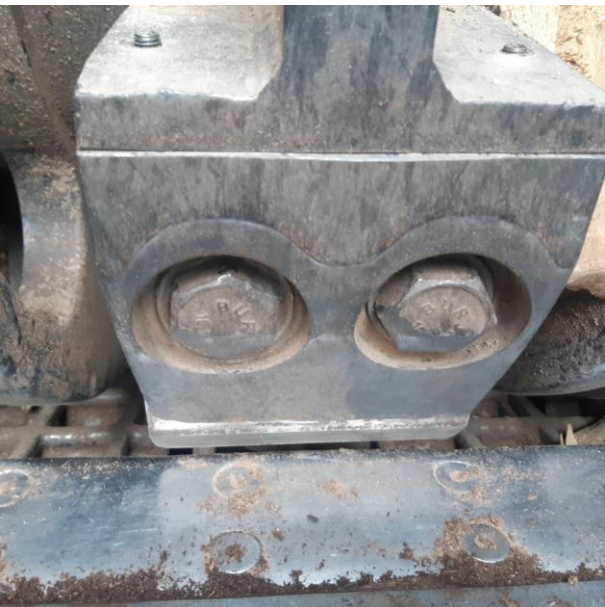
Slika 4. Nož i kontranož na bubanjskom iveraču
