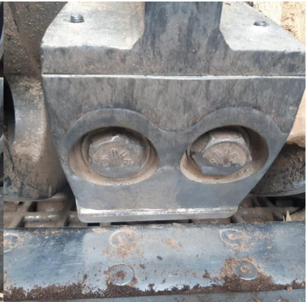
Slika 4. Nož i kontranož na bubanjskom iveraču
