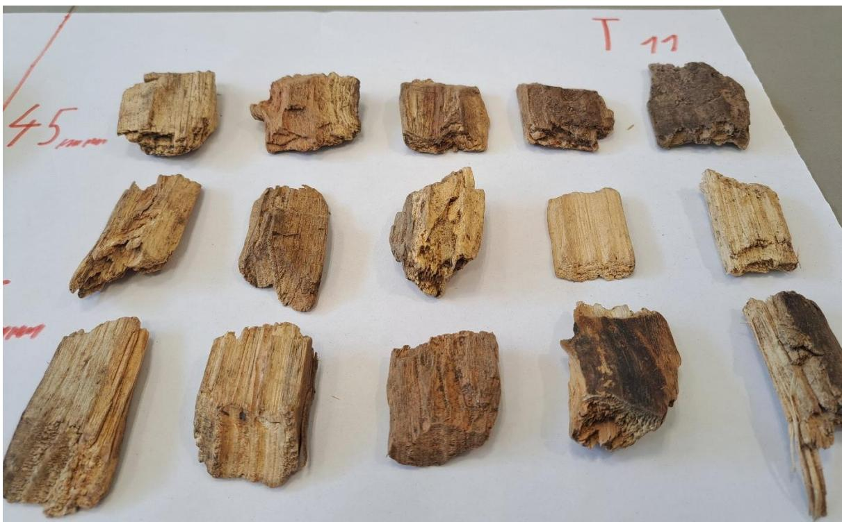
Slika 33. Uzorak T11 proizведен tupim noževima
