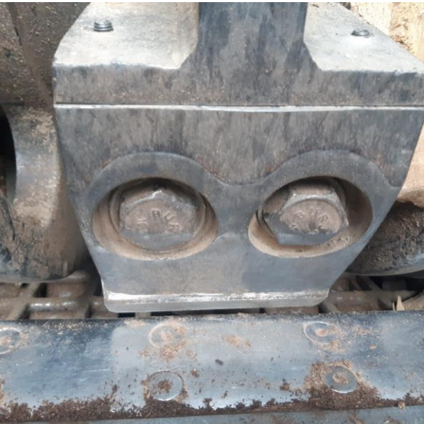
Slika 4. Nož i kontranož na bubanjskom iveraču
