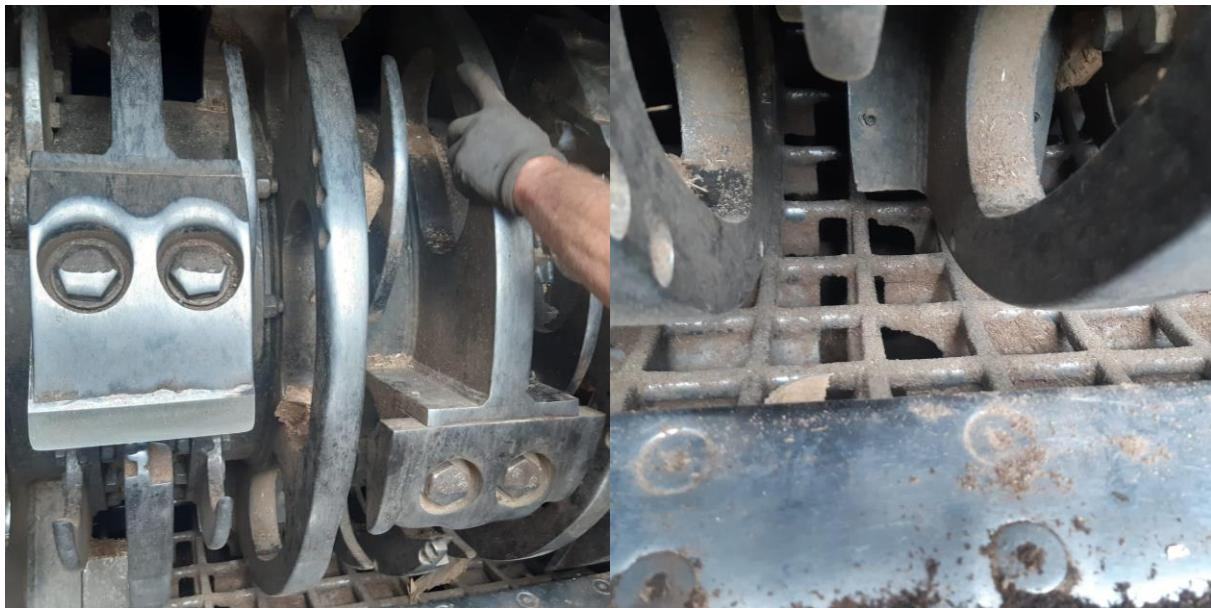
Slika 1. Nož i protuteg na bubanjskom iveraču
