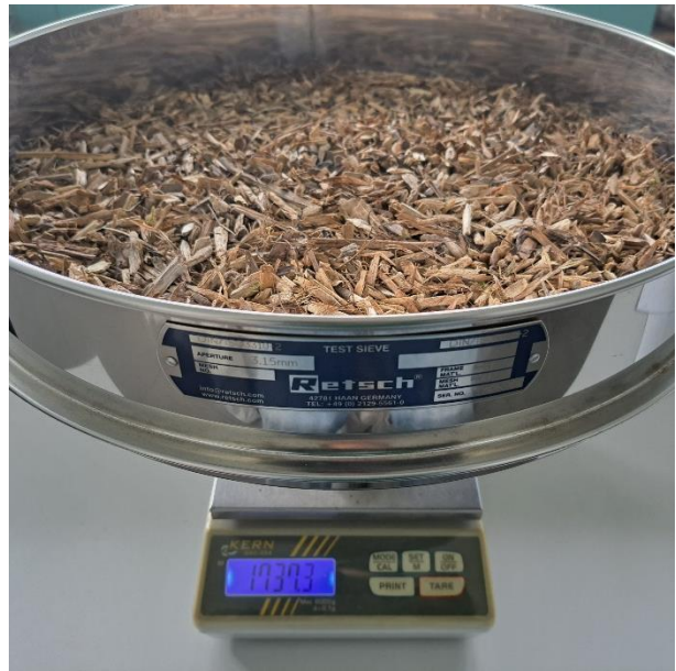
Slika 22. Određivanje mase frakcije veličine 3,15–8 mm
