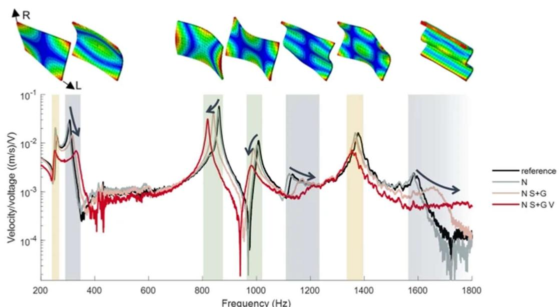
**Slika 10. Frekvencijski odzivni profili smrekove drvene ploče tijekom različitih procesa lakiranja. Radijalni načini savijanja označeni su sivom, uzdužni načini savijanja zelenom, a torzijski načini savijanja žutom bojom, redom. (Lämmlein i sur, 2019)**
