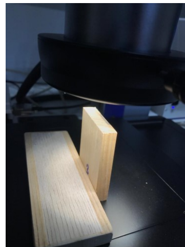
Slika 10. Mjerenje debljine filma
