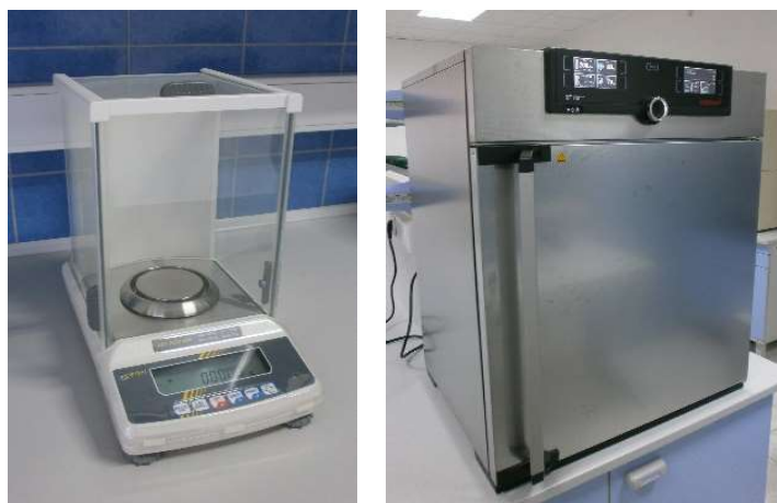
Slika 11. Analitička vaga Kern ABT 220-4M i laboratorijski sušionik Memmert UF110 plus (Foto: Katalog opreme Šumarskog fakulteta, 2014)
