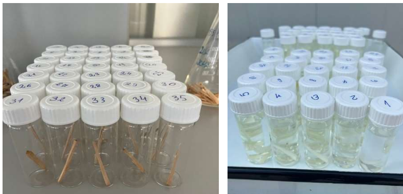
Slika 6. Uzorci drva prije tretmana (lijevo) i nakon organosolv postupka (desno)
