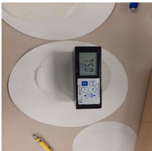
Slika 18. Mjerač bjeline PCE-WNM 100
