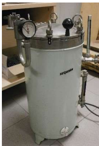
Slika 8. Laboratorijski stabilizator (Autoklav) (Izvor: Katalog opreme Šumarskog fakulteta, 2014)
