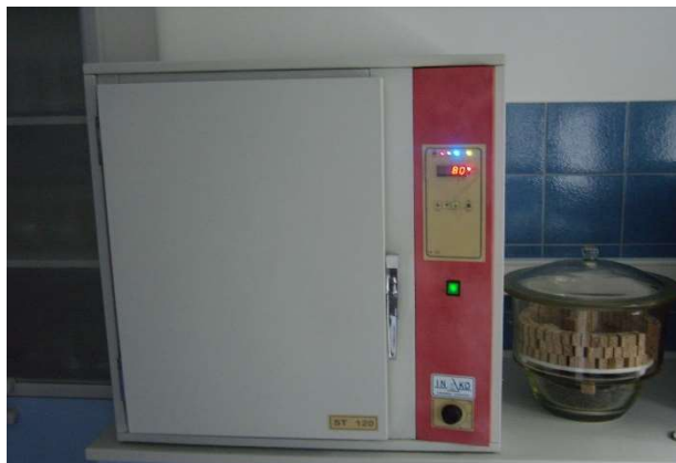
Slika 6. Sušionik INKOLab ST 120 (Izvor: Abaz,2013)
