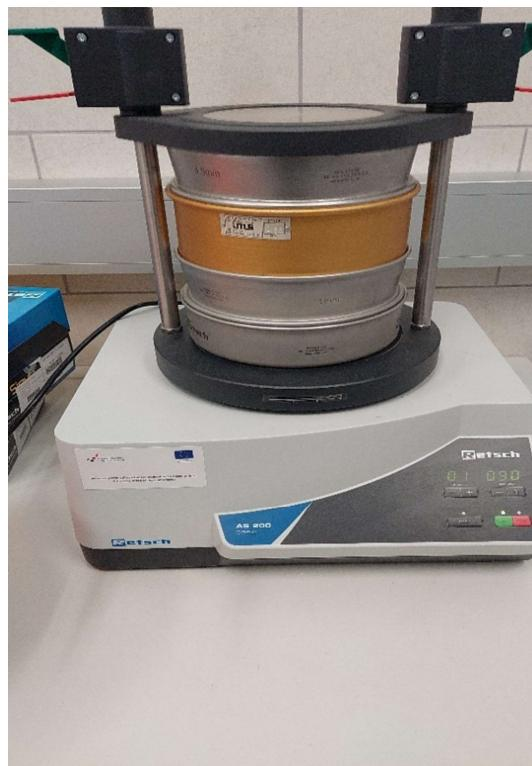
**Slika 5.** Tresilica sita Retsch AS 200
