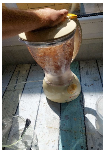
Slika 5. Razvlaknjivanje sječke kuhinjskim blenderom
