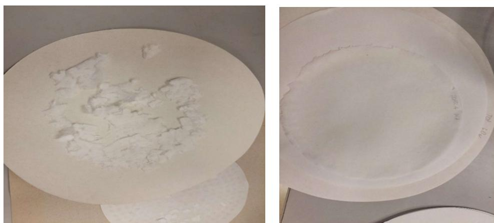
**Slika 11.** Neuspjeli pokušaj odvajanja filter papira od bugaćice s uzorkom (lijevo) i pravilno izrađen papir (desno)
