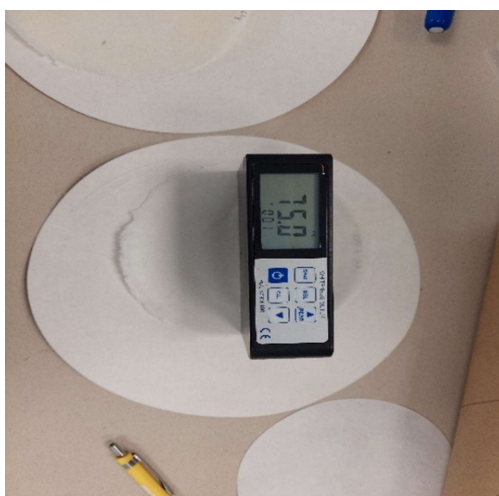
Slika 18. Mjerač bjeline PCE-WNM 100
