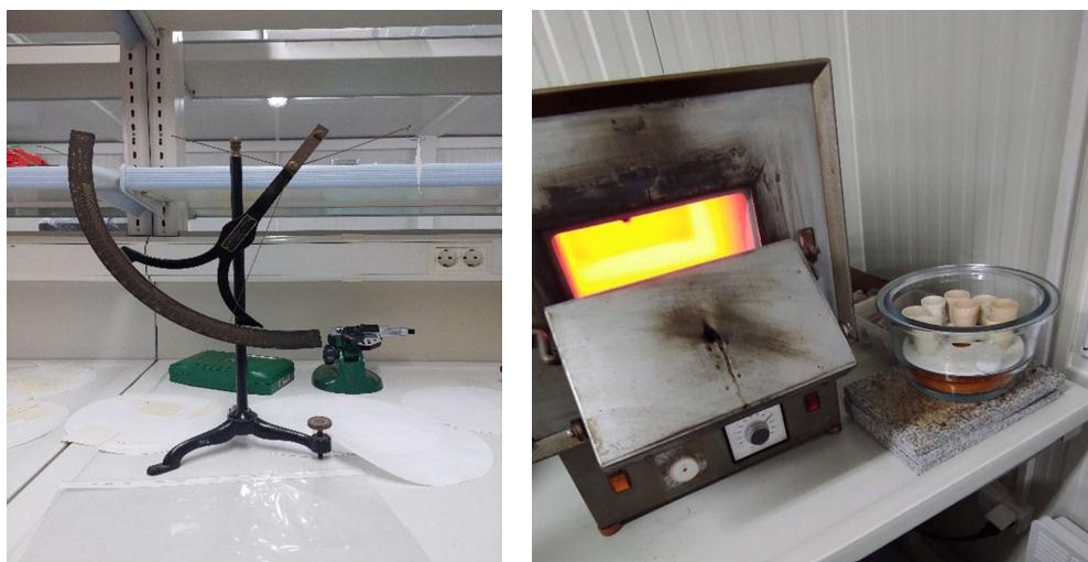
**Slika 20.** Uređaj (vaga) za mjerjenje gramature (lijevo) i Muffolna peć za žarenje (desno)
