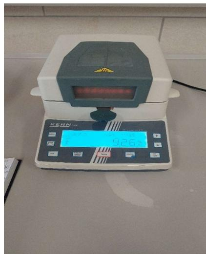
Slika 6. Analizator vlage
