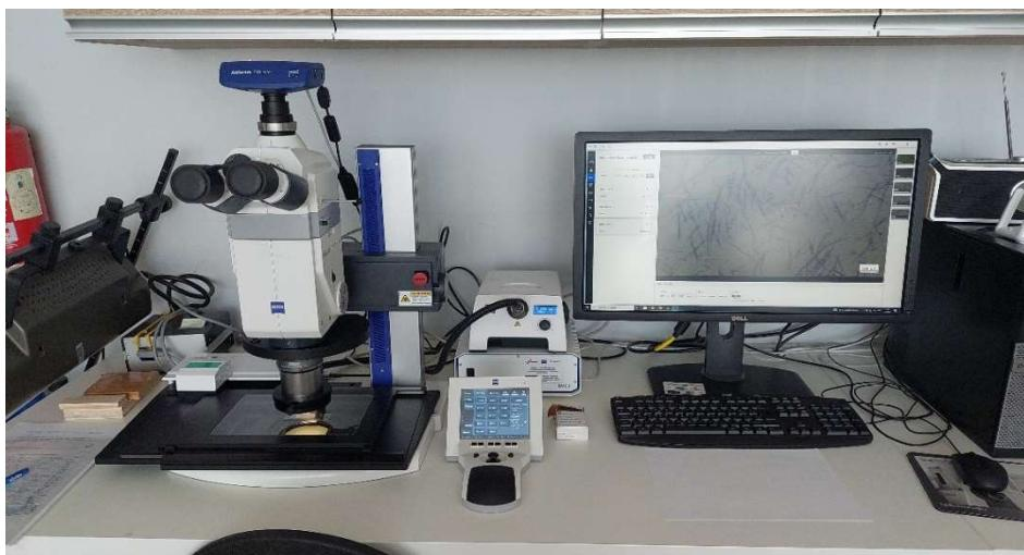
Slika 9. Istraživački mikroskop ZEISS Axis Zoom.V16
