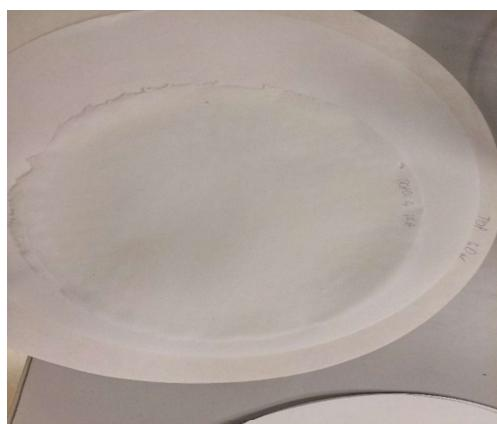
**Slika 24.** Eksperimentalni papir izrađen iz vlakana uzorka Topola IKA
