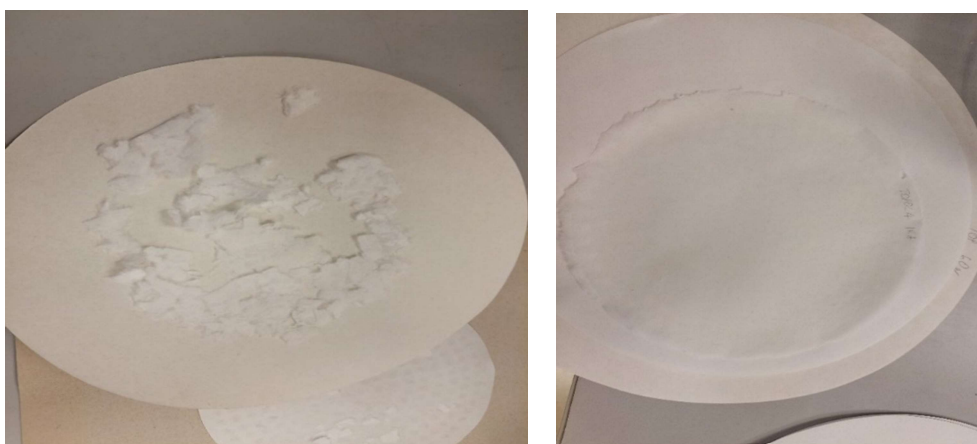
Slika 11. Neuspjeli pokušaj odvajanja filter papira od bugačice s uzorkom (lijevo) i pravilno izrađen papir (desno)
