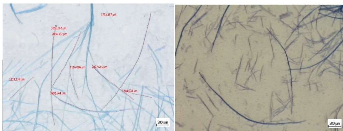
Slika 21. Mikroskopske snimke vlakana uzoraka Smreka II i Smreka I
