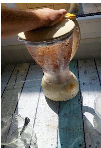
Slika 5. Razvlaknjivanje sječke kuhinjskim blenderom
