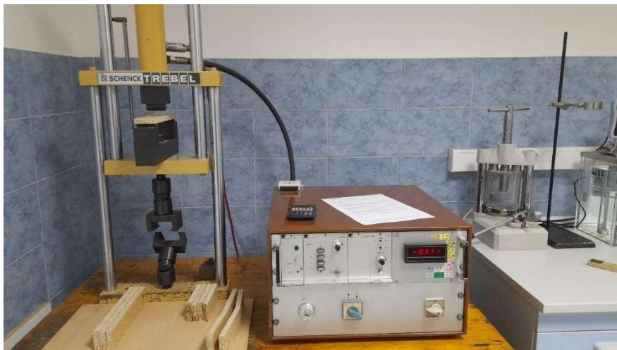
Slika 9. Uređaj za ispitivanje mehaničkih svojstava Schenck TREBEL
