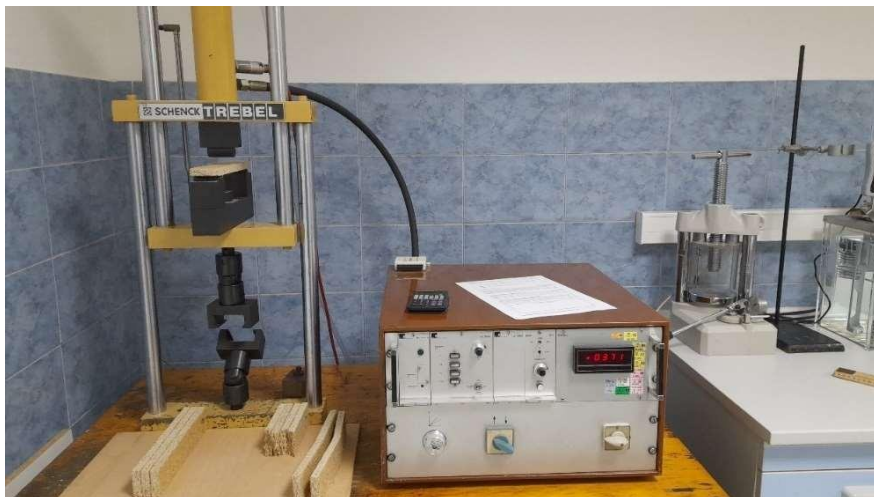
Slika 9. Uređaj za ispitivanje mehaničkih svojstava Schenck TREBEL
