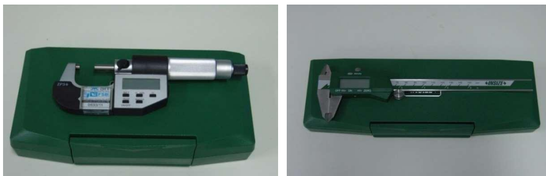
Slika 8. Digitalni mikrometar i pomično mjerilo ( Foto: Maleta, 2011.)
