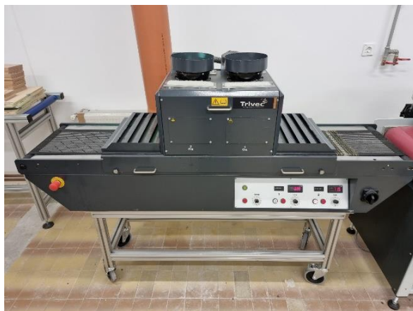
Slika 6. Stroj za sušenje premaza Trivec.
