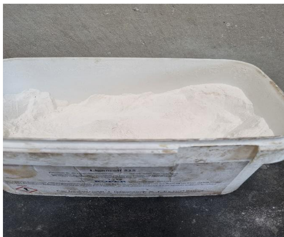
Slika 6. Ljepilo za širinsko lijepljenje
