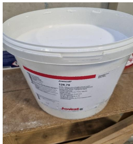
Slika 6b. Ljepilo za širinsko lijepljenje
