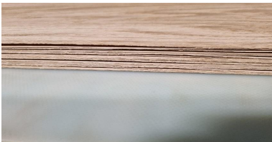
Slika 12. Fini rez noža
