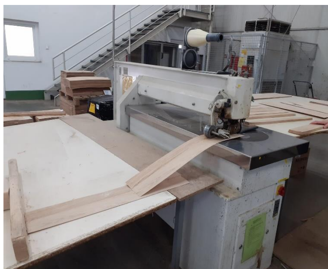
Slika 4a. Stroj za širinsko lijepljenje „cik-cak“
