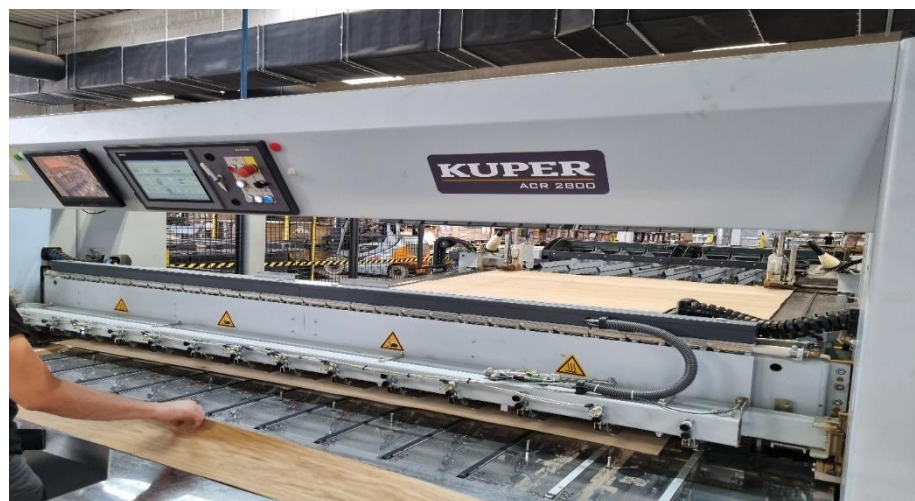
Slika 18. Stroj za spajanje furnira
