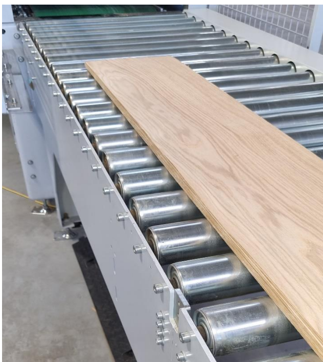
Slika 16a. Paket furnira sa nanešenim ljepilom
