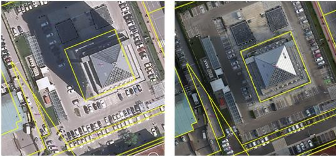
Slika 3. Primjer običnog ortofota (lijevo) i pravog ortofota (desno) ( https://www.geavis.si/en/2015/09/how-are-true-orthophoto-mosaics-made/ )
