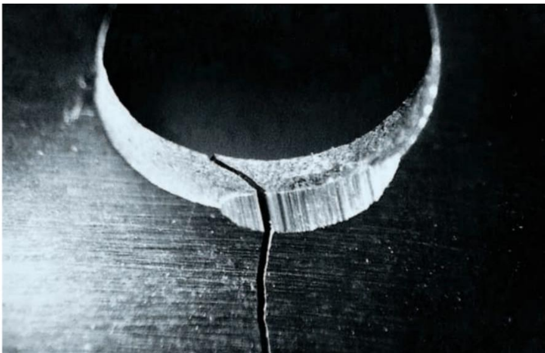
Slika 14: Prikaz loma u području pazuha kružne pile (Leitz Lexicon, 2011)
