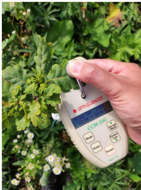
Slika 23. Prikaz mjerenja indeksa relativnog sadržaja klorofila u lišću klorofilmetrom CCM 200
