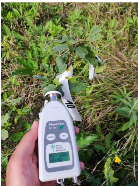
Slika 24. Prikaz mjerenja fluorescencije klorofila mjernim uređajem FluorPen FP100
