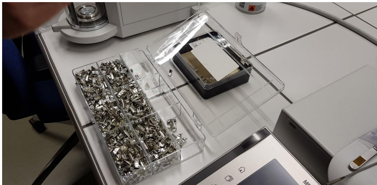
Slika 18. Srebrne kapsule za određivanje izotopa ugljika i kisika (Elementar Analysensysteme, Langenselbold, Njemačka).
