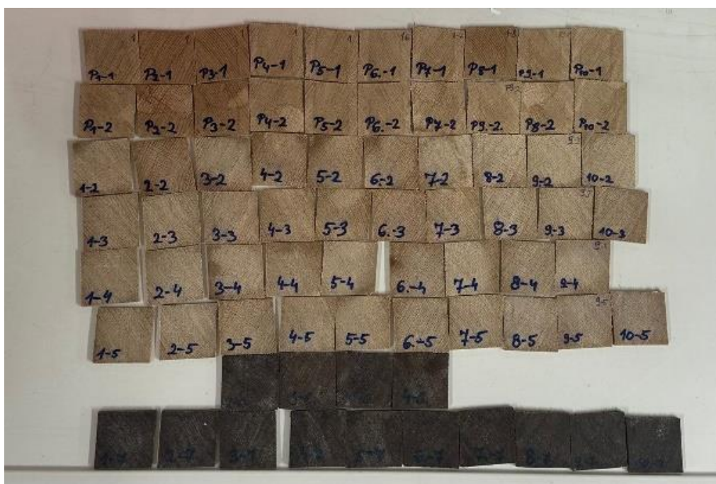
Slika 33. Svi uzorci nakon sušenja u sušioniku (foto: Tukerić E., 2024.)
