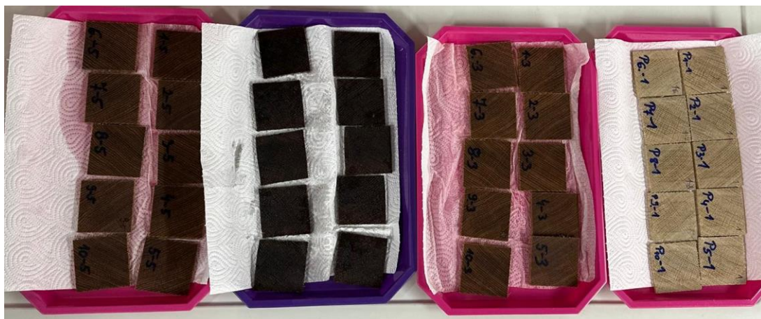
Slika 28. Različito tretirani uzorci iz 4 skupine prije vakuumskog sušenja (foto: Tukerić E., 2024.)
