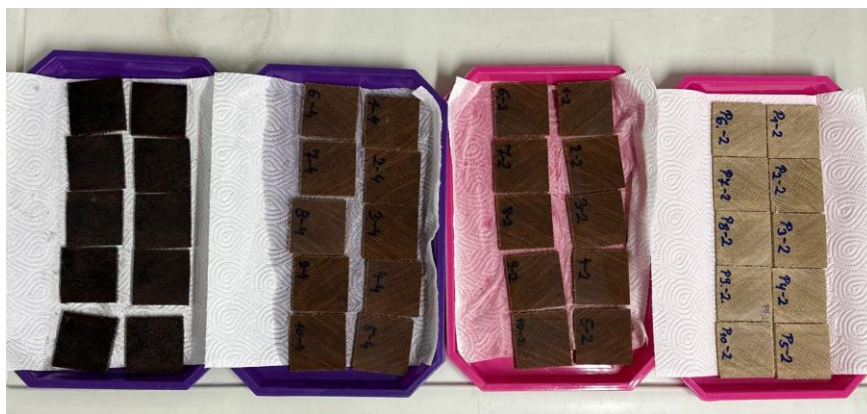
Slika 25. Različito tretirani uzorci iz 4 skupine prije liofilizacije (foto: Tukerić E., 2024.)
