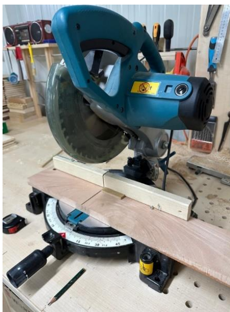
Slika 8. Stolna preklopna nagibna kružna pila (foto: Tukerić E., 2024.)
