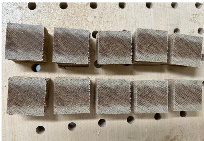
Slika 1. Uzorci sirovog drva za ispitivanje (foto: Tukerić E., 2024.)
