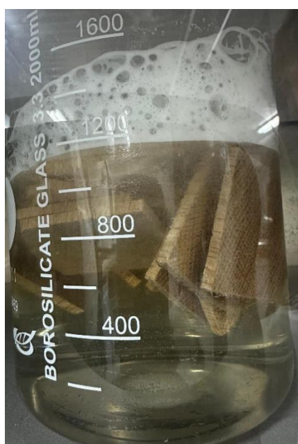
Slika 17. Izvlačenje zraka iz lumena stanica (foto: Tukerić E., 2024.)
