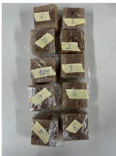
Slika 4. Uzorci raspoređeni u skupine zamotani u plastičnu foliju (foto: Tukerić E., 2024.)
