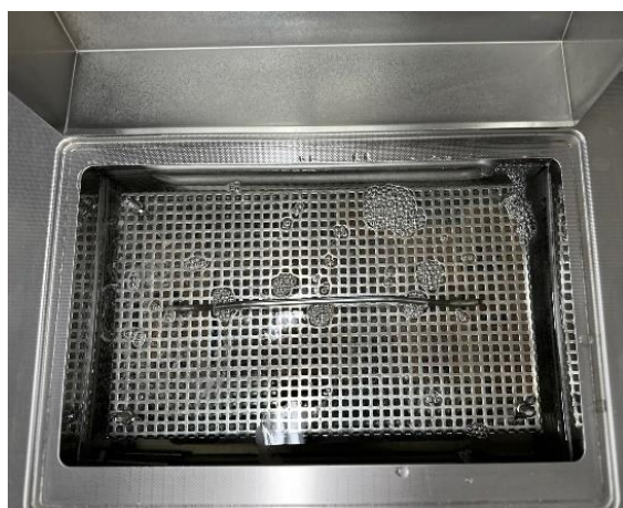
Slika 20. Rešetka s uzorcima uronjena u vodenu kupelj (foto: Tukerić E., 2024.)
