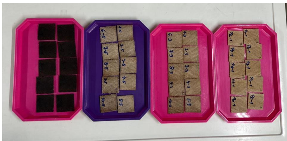
Slika 31. Različito tretirani uzorci iz 4 skupine nakon vakuumskog sušenja (foto: Tukerić E., 2024.)
