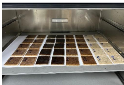
Slika 29. Uzorci složeni u vakuum sušionik prije sušenja (foto: Tukerić E., 2024.)
