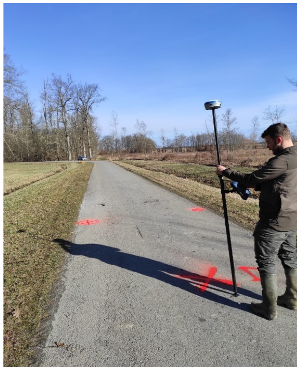
Slika 15. Snimanje GCP točke uređajem GNSS korištene za georeferenciranje aerofotografija prikupljenih bespilotnom letjelicom
