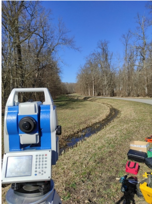
Slika 13. Prikupljanje terenskih podataka totalnom stanicom Stonex R35
